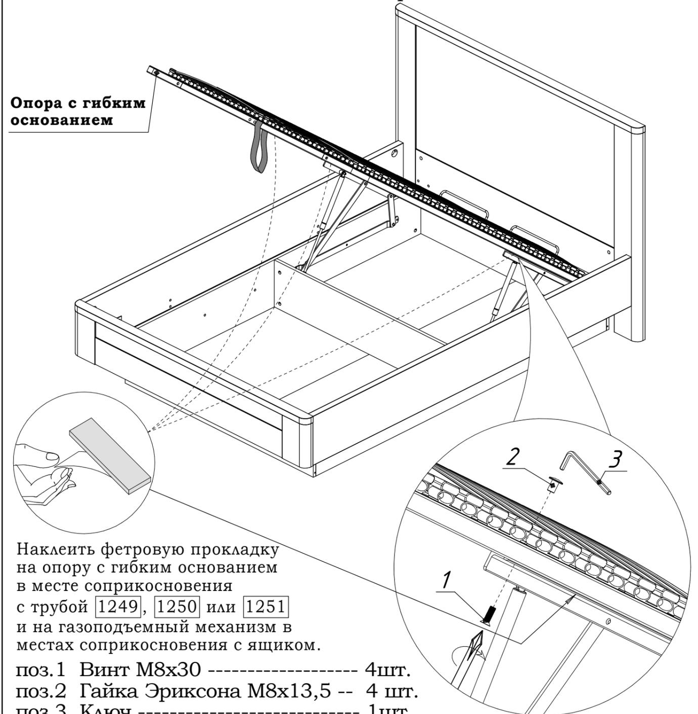
Наклеить фетровую прокладку на опору с гибким основанием в месте соприкосновения с трубой 1249, 1250 или 1251 и на газоподъемный механизм в местах соприкосновения с ящиком.
