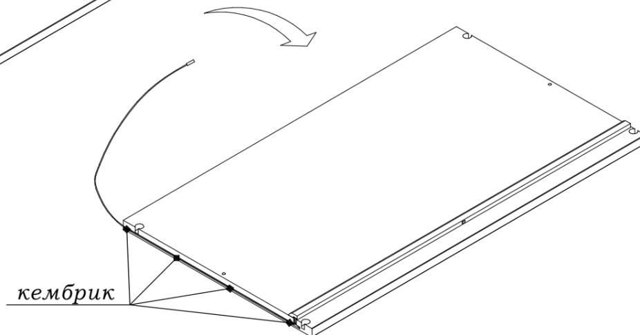
2. Защёлкните светильник на клипсы, провод от светильника вставить в паз полки, для предохранения провода от выпадания из паза вставить кембрики, равномерно распределив их по длине паза.
