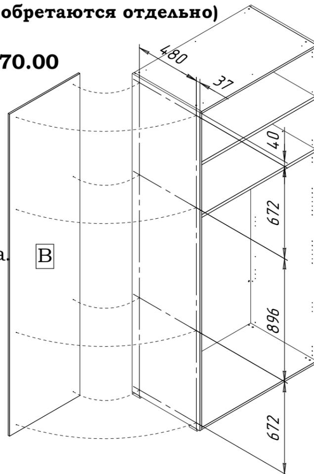
Досверлить электродрелью в стенке боковой шкафа отверстия  $\phi$  5мм на указанных расстояниях, приложив с лицевой стороны кусок ЛДСП или дощечку для предохранения от скола.
