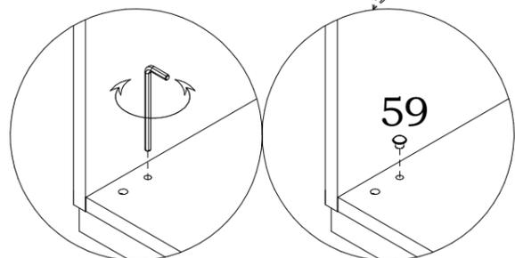
Выравнивание шкафа по высоте произвести вращением опор с помощью шестигранного ключа 6мм или отвертки с прямым или крестообразным шлицем
