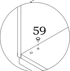
Выравнивание шкафа по высоте произвести вращением опор с помощью шестигранного ключа 6мм или отвертки с прямым или крестообразным шлицем
