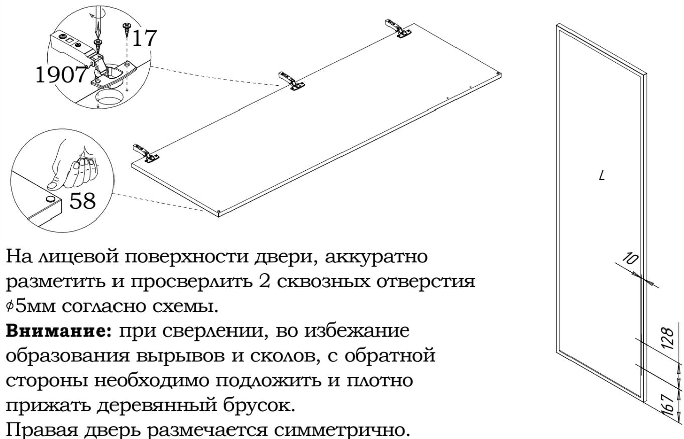
На лицевой поверхности двери, аккуратно разметить и просверлить 2 сквозных отверстия  $\phi 5$ мм согласно схемы.
