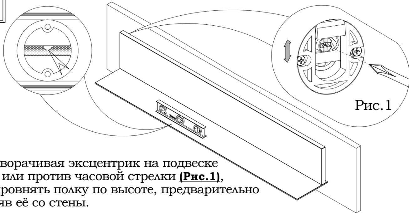
Поворачивая эксцентрик на подвеске по или против часовой стрелки (**Рис. 1**), выровнять полку по высоте, предварительно сняв её со стены.
