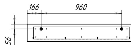
Схема полки 24.019.00.00 (-01) (вид сзади)
