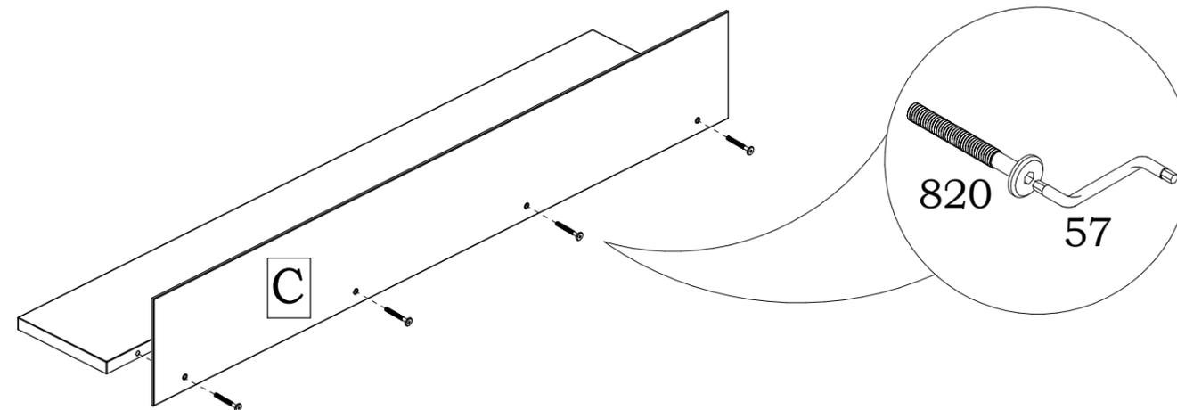
Положите стенку вертикальную на мягкий предохранительный материал, затем приставьте стеклянную полку С и поддерживая руками вставьте винты **поз. 820** в отверстия и **аккуратно** затяните ключом **поз. 57**.
