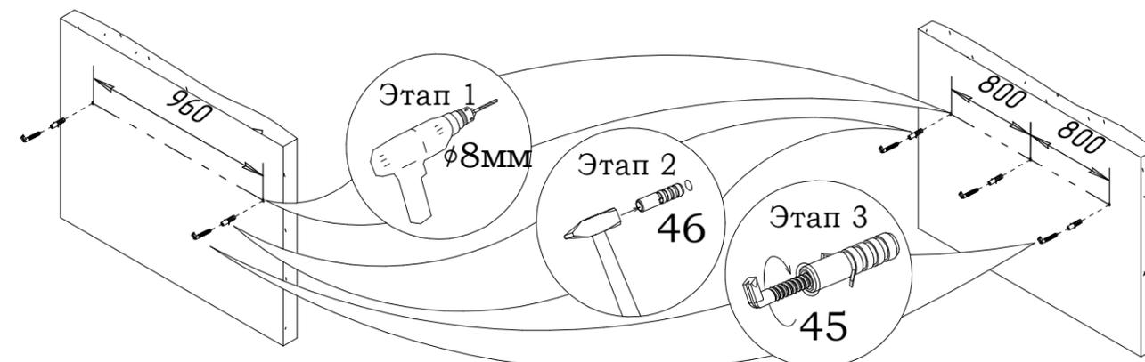
Согласно прилагаемой схеме произвести засверловку отверстий в стене под дюбель **46**. Сверление выполнить глубиной не менее 40мм
