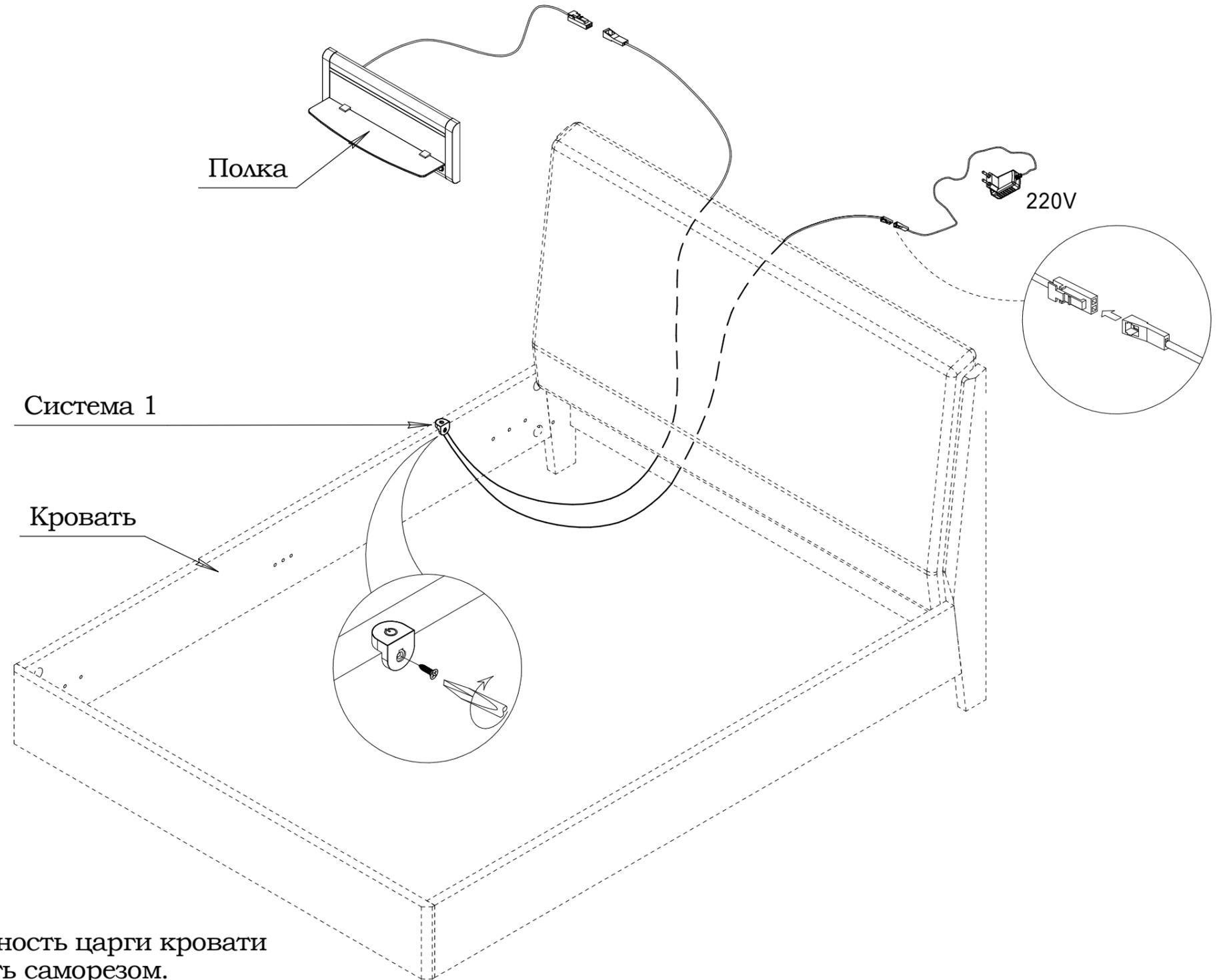
Систему 1 установить на внутреннюю поверхность царги кровати в удобном для эксплуатации месте и закрепить саморезом.
