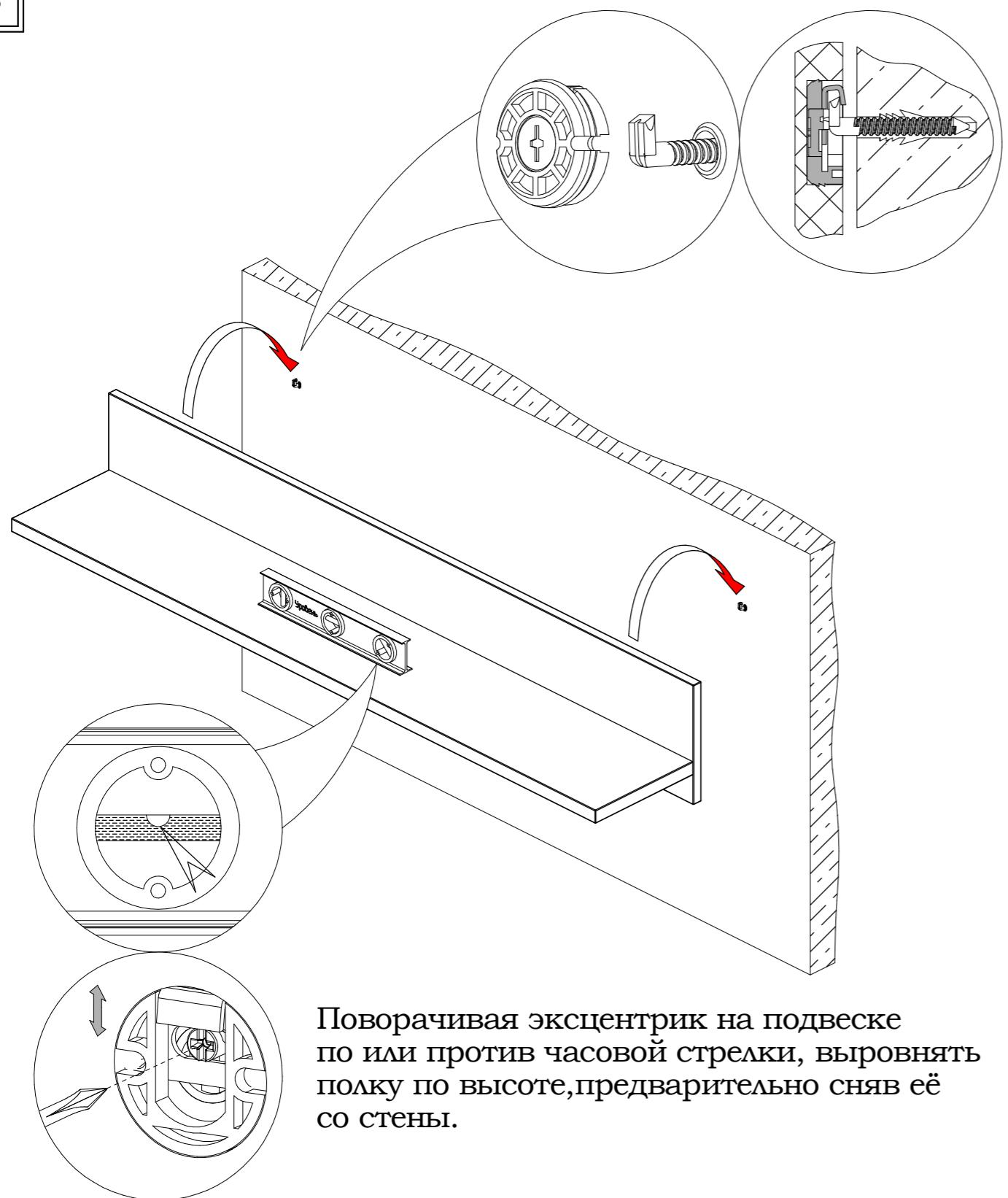
Поворачивая эксцентрик на подвеске по или против часовой стрелки, выровнять полку по высоте, предварительно сняв её со стены.
