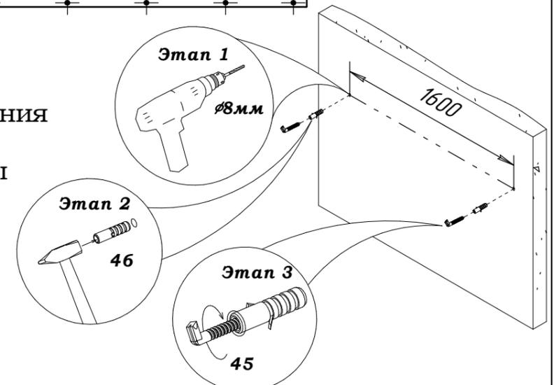
Согласно прилагаемой схеме произвести засверловку отверстий в стене под дюбель 46. Сверление выполнить глубиной не менее 40мм
