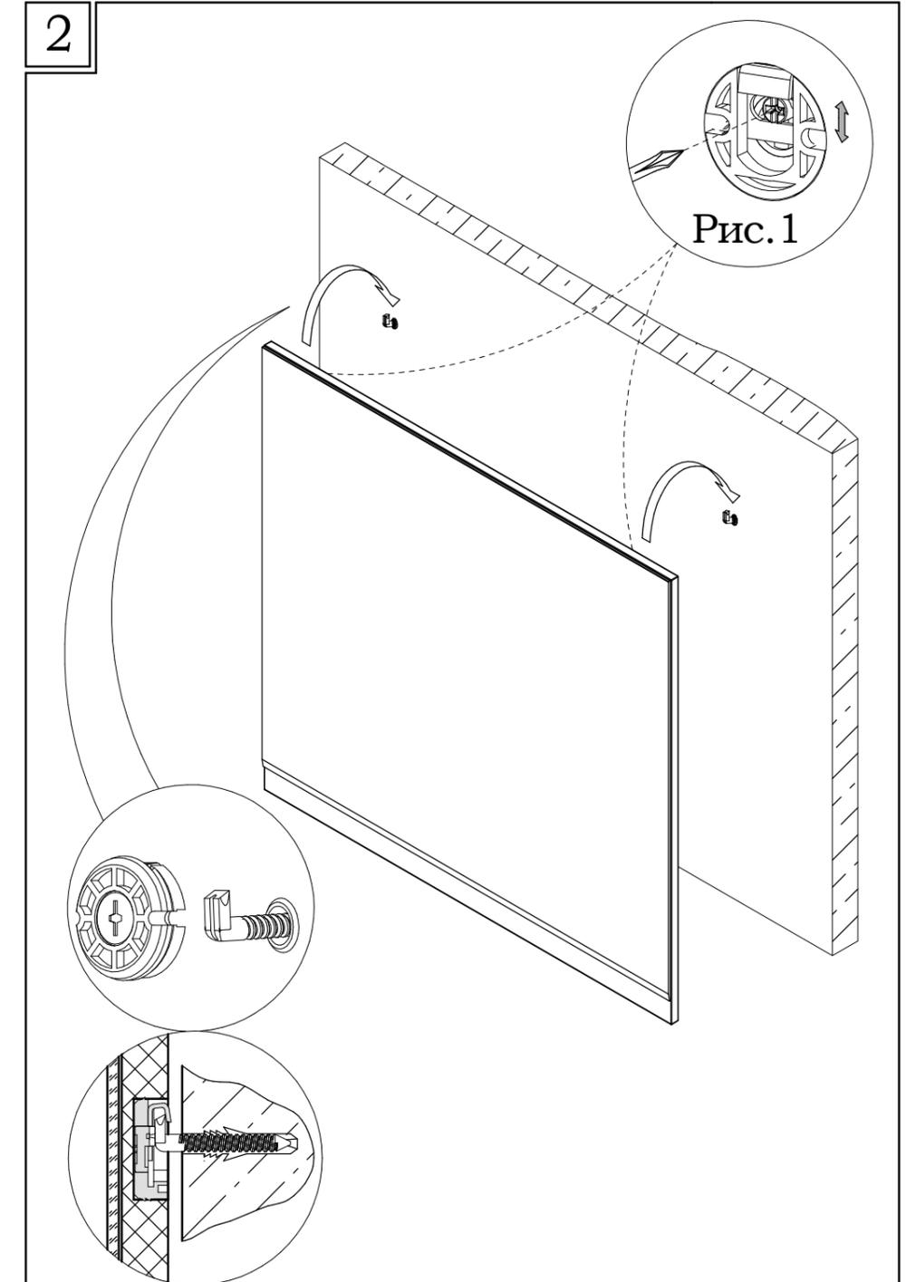
Поворачивая эксцентрик на подвеске по или против часовой стрелки (**Рис. 1**), выровнять панель с зеркалом по высоте, предварительно сняв её со стены.
