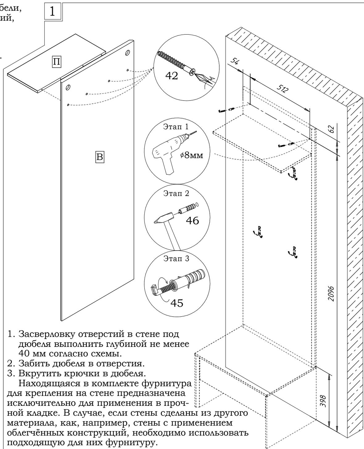
1. Засверловку отверстий в стене под дюбеля выполнить глубиной не менее 40 мм согласно схеме.
