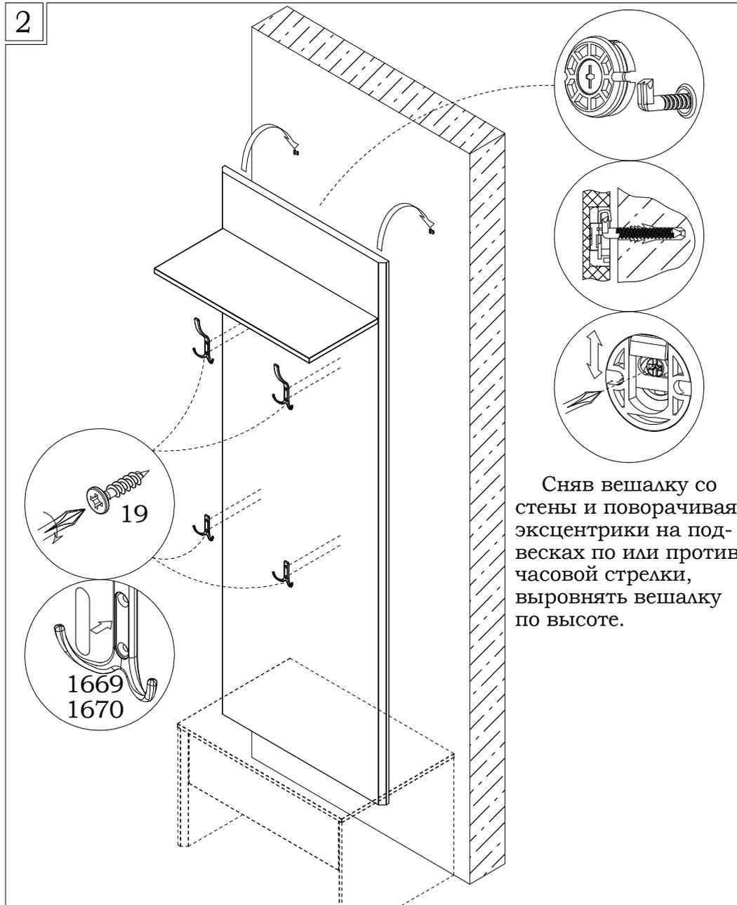
Сняв вешалку со стены и поворачивая эксцентрики на подвесках по или против часовой стрелки, выровнять вешалку по высоте.
