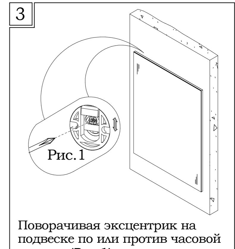
Поворачивая эксцентрик на подвеске по или против часовой стрелки (**Рис.1**), выровнять панель по высоте, предварительно сняв её со стены.
