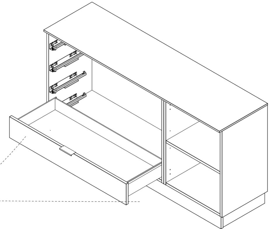
1. Выдвинуть направляющие, вставить ящик под наклоном так, чтобы два отверстия на стенке задней ящика попали на крючки;
