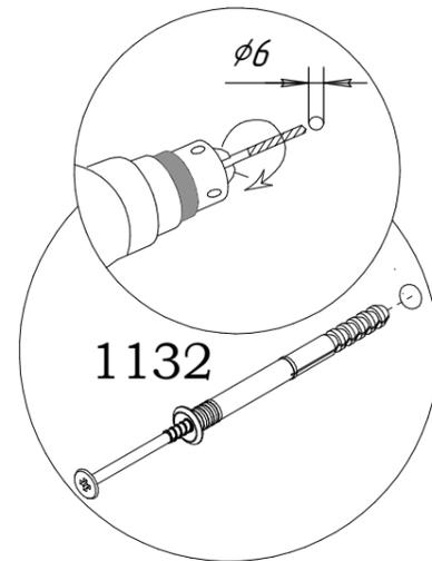
1. Просверлить два отверстия  $\phi 6$  мм в задней стенке **З** и **Ш** на заданном расстоянии.
