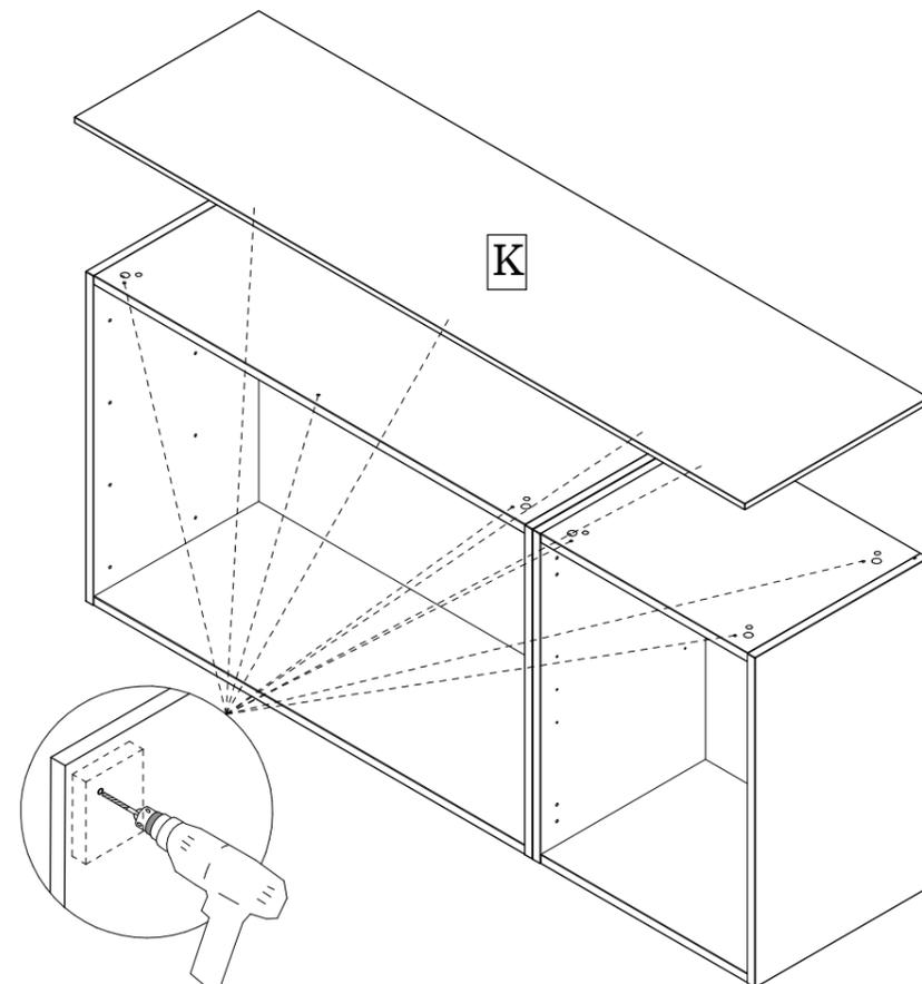
Досверлите указанные отверстия сверлом  $\phi 5$  мм, приложив с нижней стороны кусок ЛДСП или дощечку для предохранения от скола.
