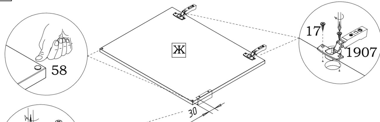
1. Приложить ручку **2011** к фасаду согласно схеме и с тыльной стороны фасада наколоть отверстия в соответствии с межосевым расстоянием.
