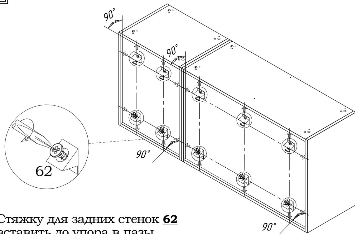
Стяжку для задних стенок 62 вставить до упора в пазы, расклинив заднюю стенку, и зафиксировать её шурупом.
