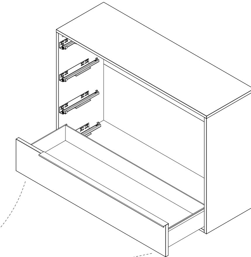
1. Выдвинуть направляющие, вставить ящик под наклоном так, чтобы два отверстия на стенке задней ящика попали на крючки;
