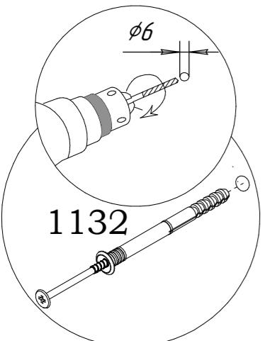
1. Просверлить два отверстия  $\phi 6$  мм в задней стенке **3** на заданном расстоянии.
