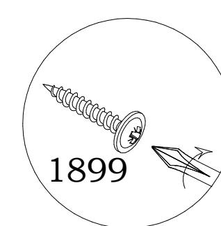
Для присоединения крышки **K** необходимо предварительно просверлить 6 отверстия  $\phi 5$  мм в стенке горизонтальной **O**, приложив со стороны выхода сверла кусок ЛДСП или дощечку для предохранения от скола При монтаже крышку позиционировать по задней кромке.
