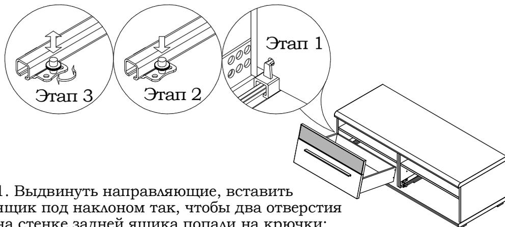
1. Выдвинуть направляющие, вставить ящик под наклоном так, чтобы два отверстия на стенке задней ящика попали на крючки;
