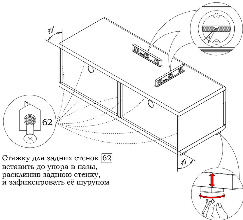
Стяжку для задних стенок 62 вставить до упора в пазы, расклинив заднюю стенку, и зафиксировать её шурупом
