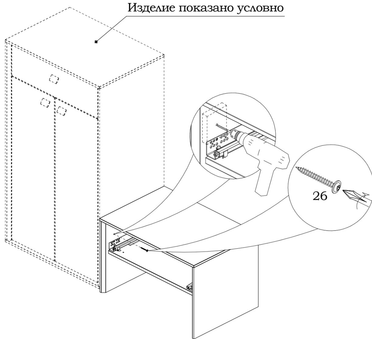
Для соединения тумбы с другими изделиями (при необходимости) в боковине тумбы просверлить электродрелью отверстия  $\phi 5\text{мм}$ , приложив с лицевой стороны кусок ЛДСП или дощечку для предотвращения скола. Затем выровнять изделия по передней кромке и соединить их между собой при помощи саморезов **26**.
