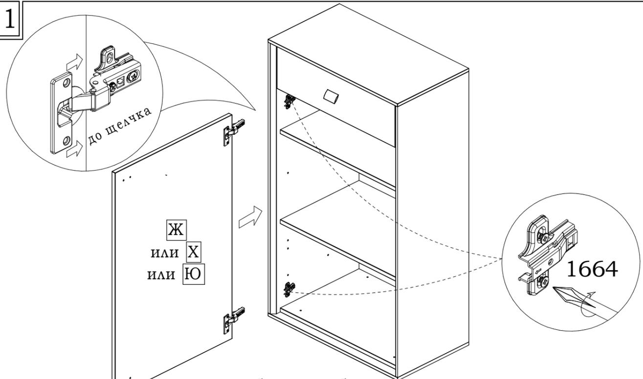
В случае сборки тумбы с левым открыванием двери планка **1664** устанавливается на противоположную стенку боковую
