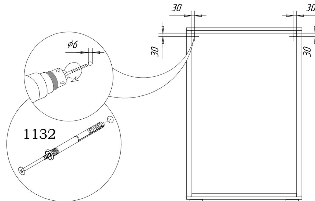
1. Просверлить отверстия  $\phi 6$  мм в задней стенке **3** на заданном расстоянии.
