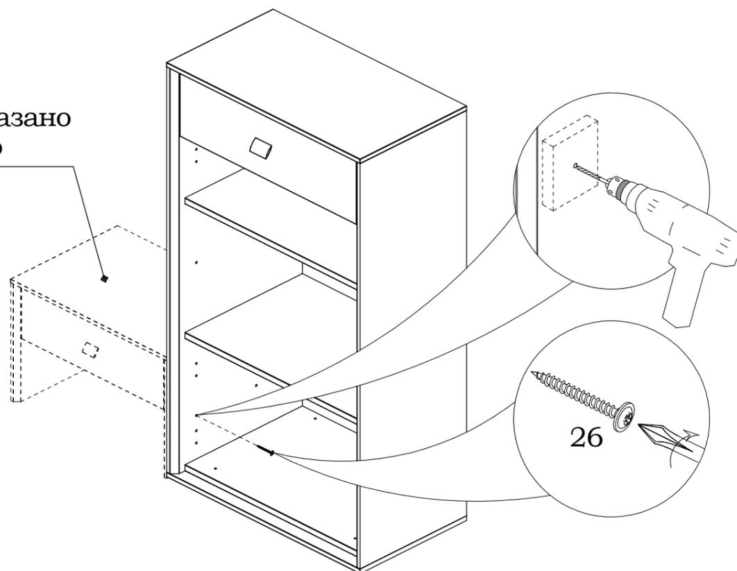
Для соединения тумбы с другими изделиями (при необходимости) в боковине тумбы просверлить электродрелью отверстия  $\phi 5$  мм, приложив с лицевой стороны кусок ЛДСП или дощечку для предотвращения скола. Затем выровнять изделия по передней кромке и соединить их между собой при помощи саморезов **26**.
