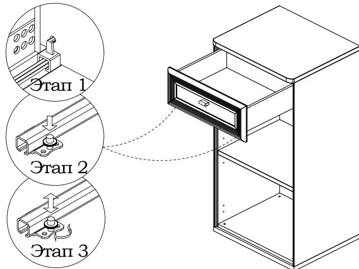
1. Выдвинуть направляющие, вставить ящик под наклоном так, чтобы два отверстия на стенке задней ящика попали на крючки;
