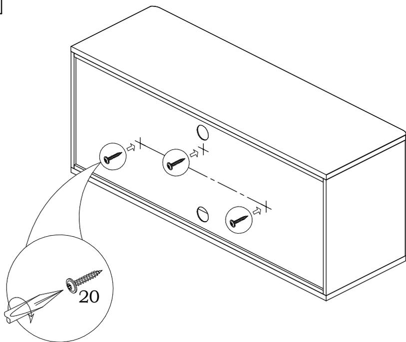
Закрепите заднюю стенку шурупами **20** к горизонтальной стенке согласно разметке, показанной на виде сзади.
