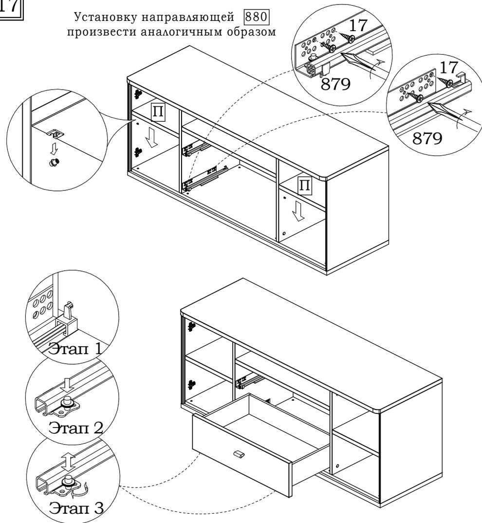
1. Выдвинуть направляющие, вставить ящик под наклоном так, чтобы два отверстия на стенке задней ящика попали на крючки;
