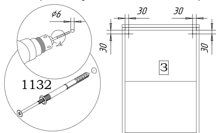
1. Просверлить два отверстия  $\phi 6$  мм в задней стенке **3** на заданном расстоянии.
