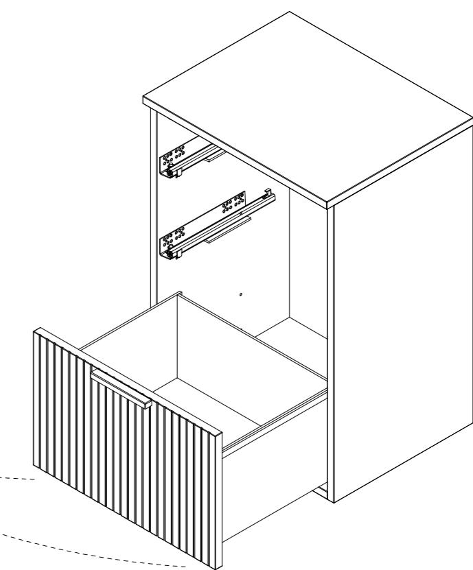
1. Выдвинуть направляющие, вставить ящик под наклоном так, чтобы два отверстия на стенке задней ящика попали на крючки;
