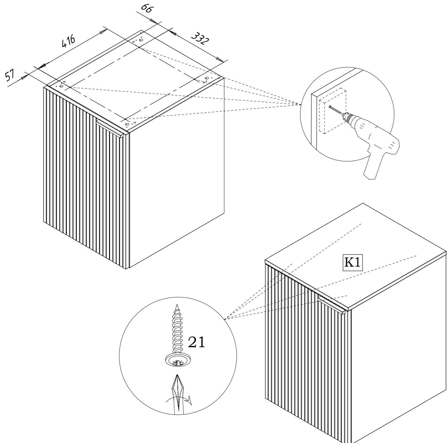
1. По приведённой разметке просверлите отверстия  $\phi 5\text{мм}$ ; (существующие наколки досверлите)
