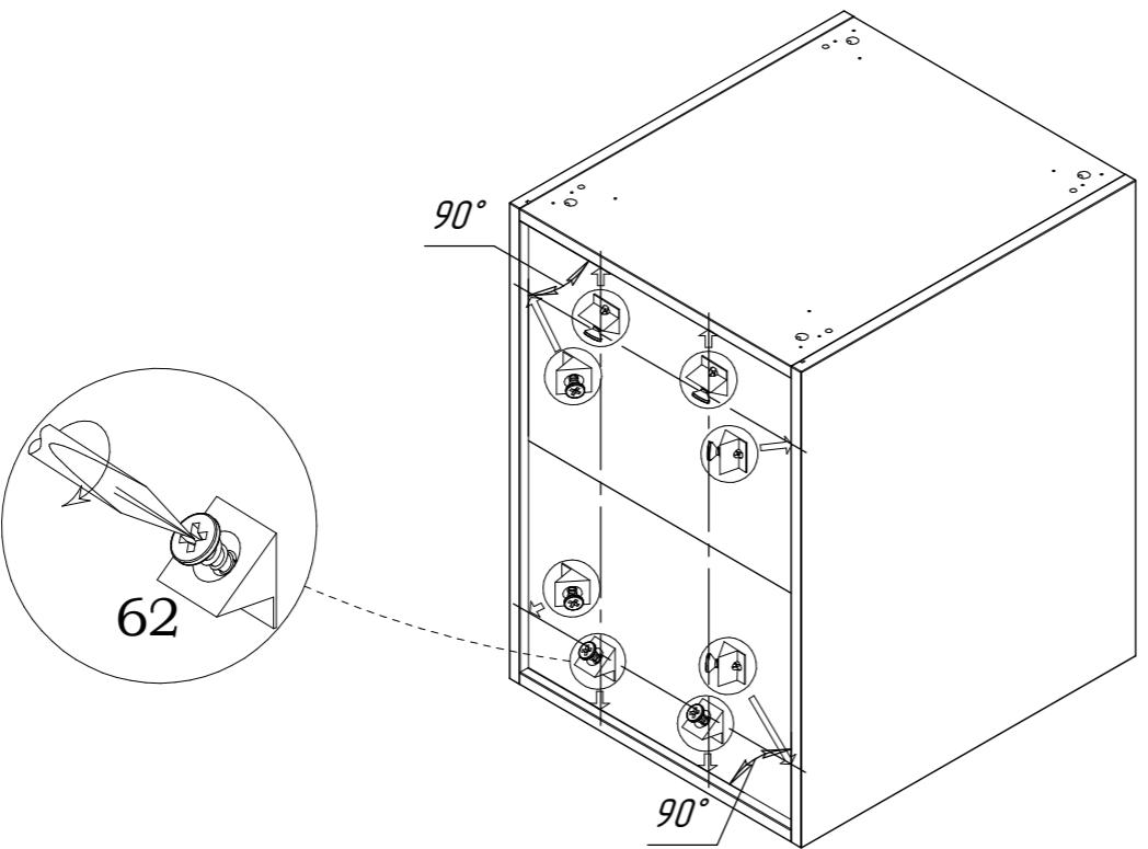
Стяжку для задних стенок **62** вставить до упора в пазы, на расстоянии 100мм. от угла, расклинив заднюю стенку, и зафиксировать её шурупом.
