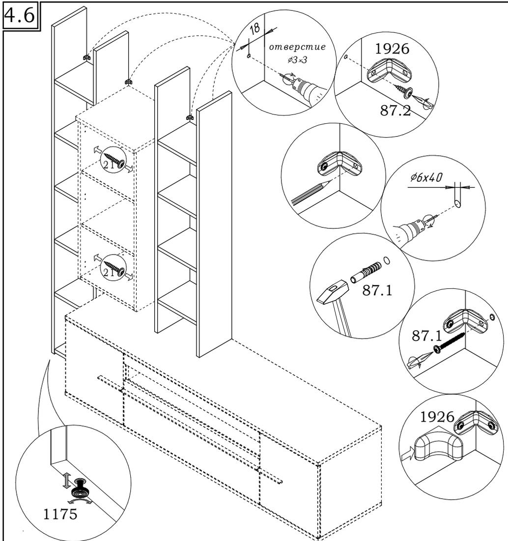
1. Установите две ранее собранные части стеллажа (см. п. 4.4) к заранее выравненной по уровню тумбе (на тумбу) вплотную к шкафу навесному.
