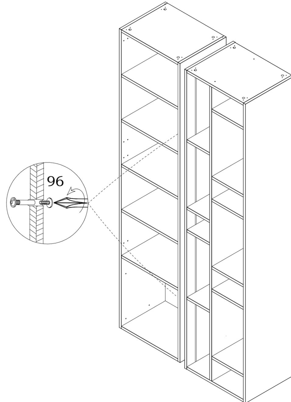
Для соединения стеллажа с другими изделиями, через боковины просверлить электродрелью отверстия  $\phi$  5 мм, предварительно выровняв стеллаж и изделие по высоте и по задним торцевым кромкам. Соединить их при помощи межсекционных стяжек 96 .
