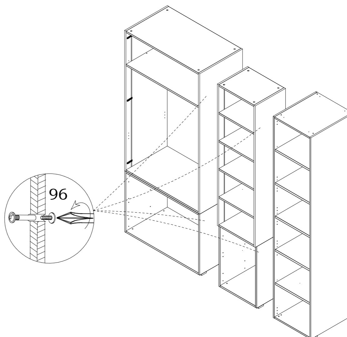
Для соединения шкафа с другими изделиями, через боковины просверлить электродрелью отверстия  $\phi 5\text{мм}$ , предварительно выровняв шкаф и изделие по высоте. Тумбы выровнять по передним кромкам. Соединить их при помощи межсекционных стяжек 96 .
