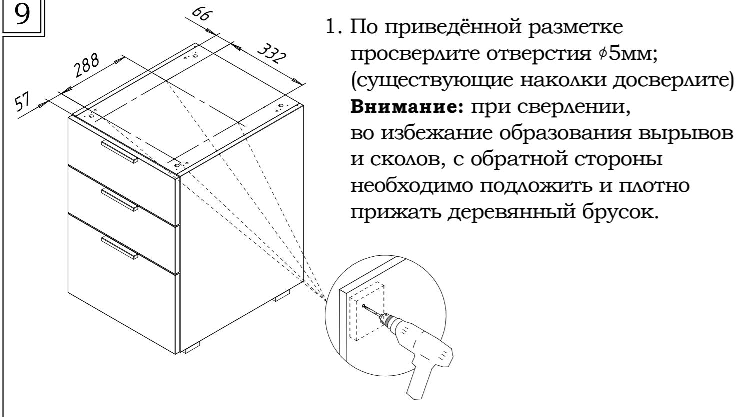
1. По приведённой разметке просверлите отверстия  $\phi 5\text{мм}$ ; (существующие наколки досверлите)
