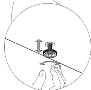
Выравнивание тумбы по высоте произвести поворачиванием вращающихся частей регулируемых опор.
