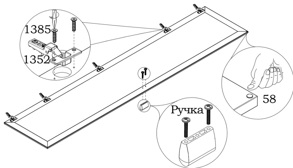
Перед установкой ручки досверлите отверстия сверлом  $\phi 5$  мм.
