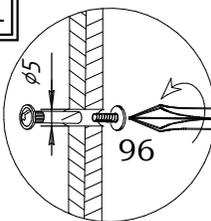
Соединить изделия при помощи межсекционных стяжек **96** через отверстия в стенках боковых. Отверстия  $\phi 5$  мм просверлить электродрелью в стенках боковых, предварительно выровняв изделия по высоте.
