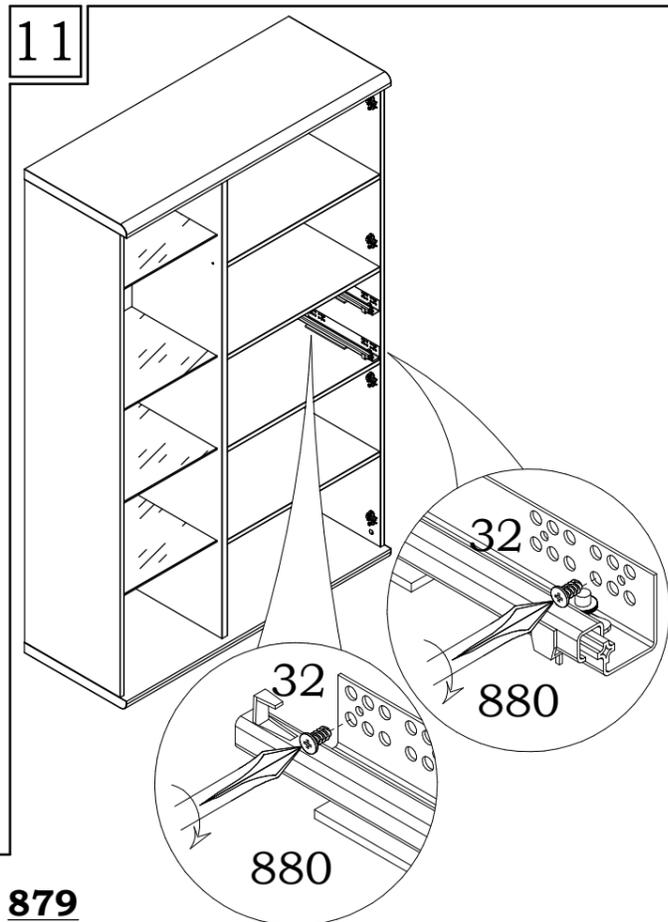
К перегородке Г направляющие 879 крепятся с помощью винтов 827 и адаптеров 901.
