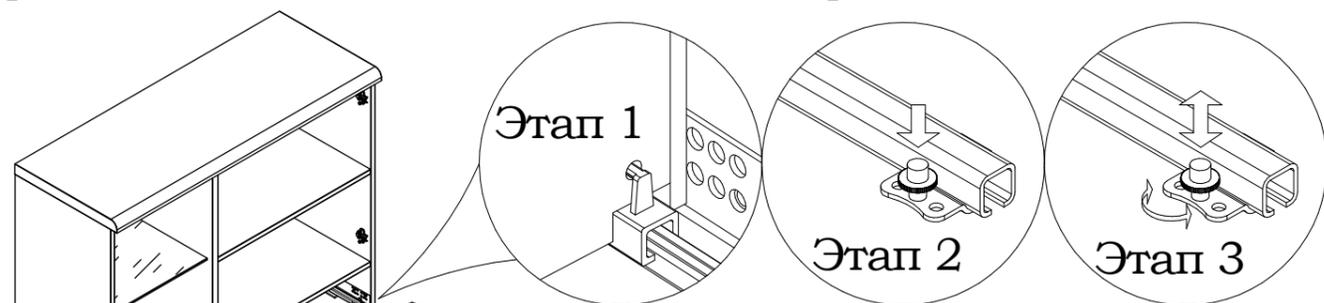
1. Выдвинуть направляющие, вставить ящик под наклоном так, чтобы два отверстия на стенке задней ящика попали на крючки;
