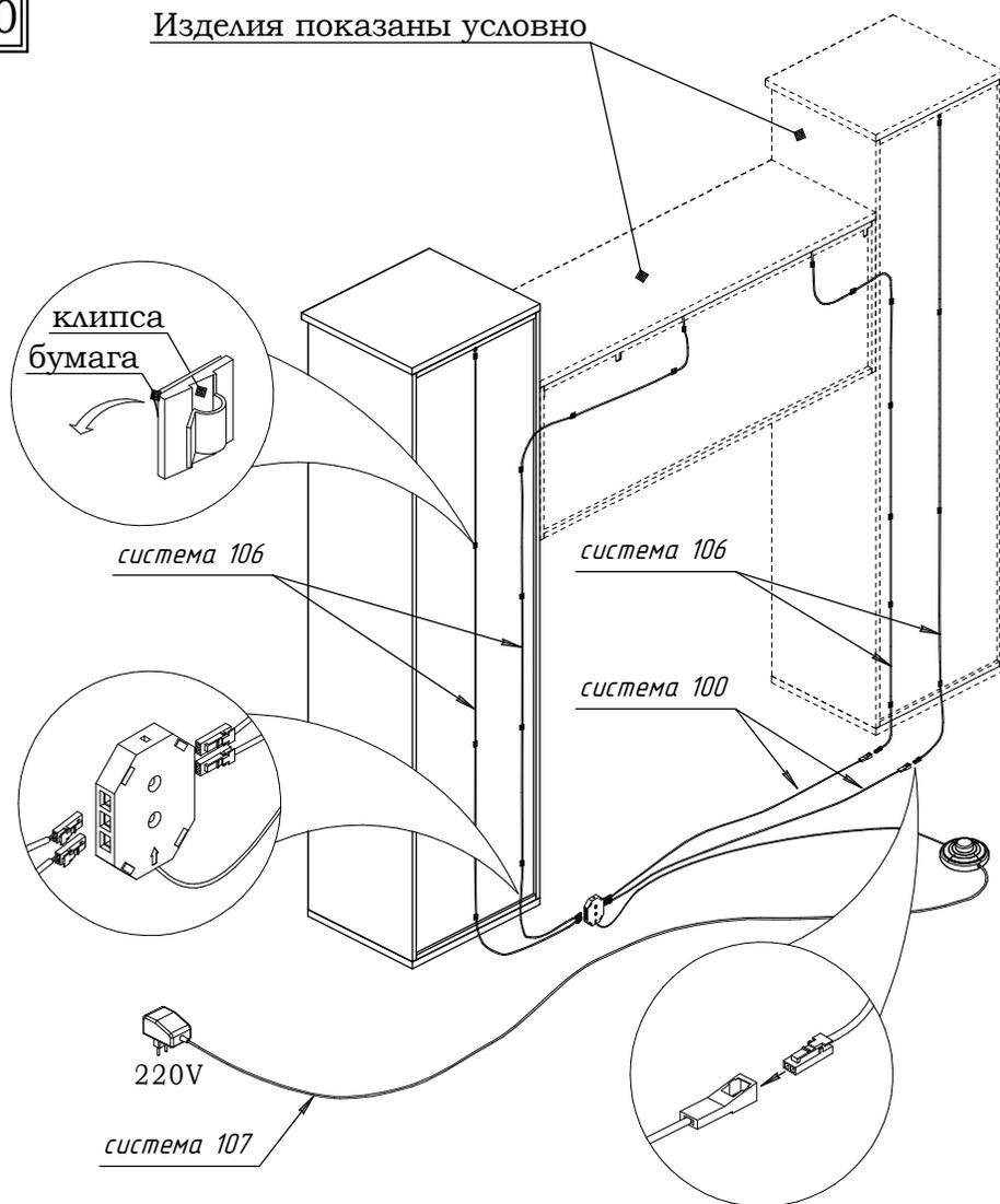
После завершения установки всех изделий в комбинации, соедините **системы 106** и **107** между собой. При необходимости в качестве удлинителя используйте **систему 100**
