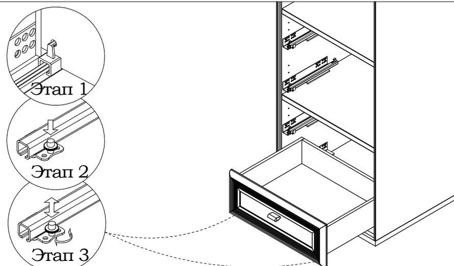
1. Выдвинуть направляющие, вставить ящик под наклоном так, чтобы два отверстия на стенке задней ящика попали на крючки;
