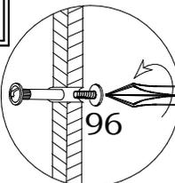
Для соединения шкафа с другими изделиями, через боковины просверлить электродрелью отверстия  $\phi 5$  мм, предварительно выровняв шкаф и изделие по высоте. Соединить их при помощи межсекционных стяжек 96.
