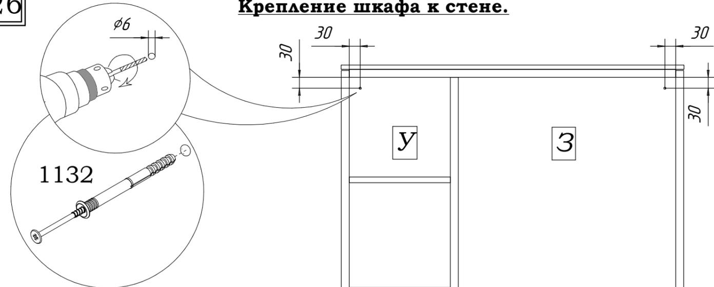
1. Просверлить отверстия  $\phi 6$  мм в задней стенке **З** и **У** на заданном расстоянии.
