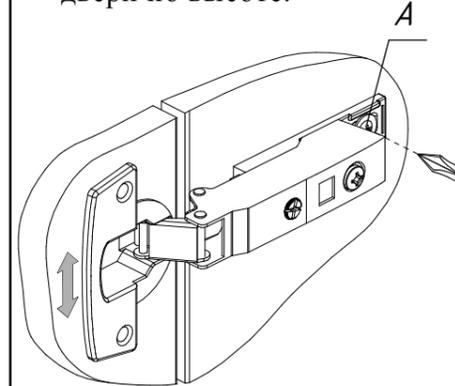
**б) Регулирование глубины**
