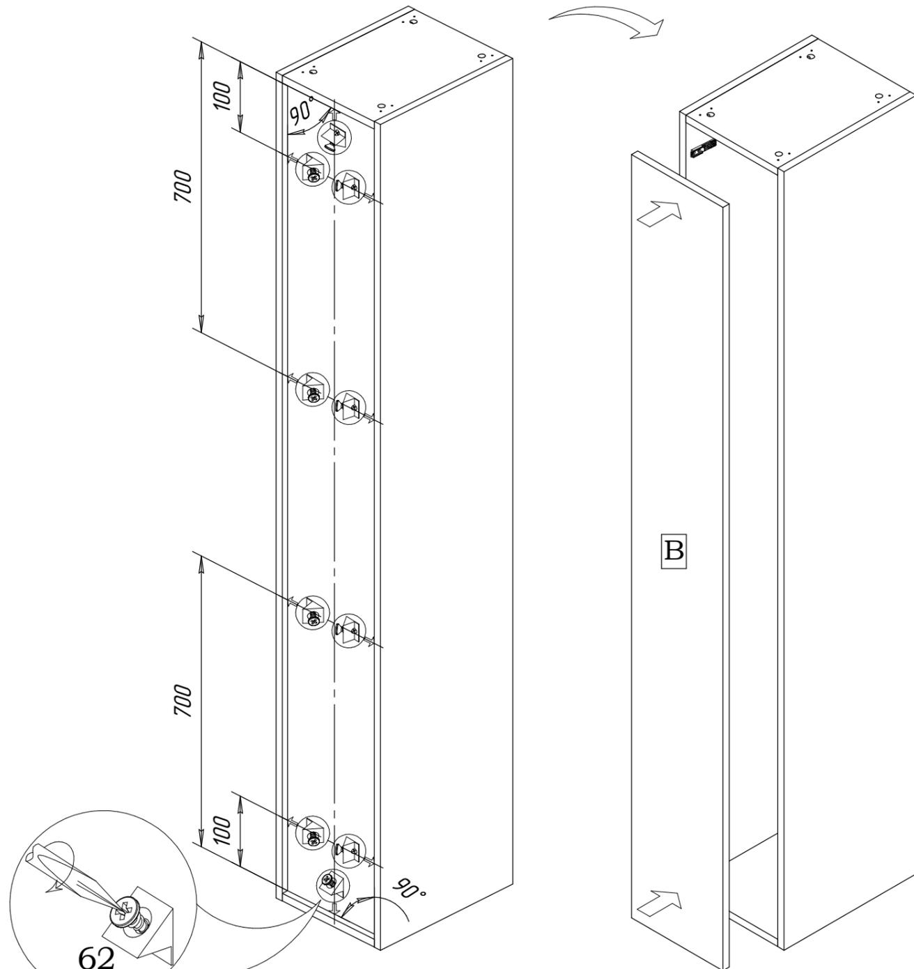
Стяжку для задних стенок **62** вставить до упора в пазы, расклинив заднюю стенку и зафиксировать её шурупом.
