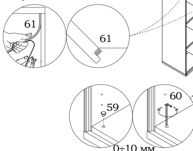
Выравнивание шкафа по высоте произвести вращением опор с помощью шестигранного ключа **60**.
