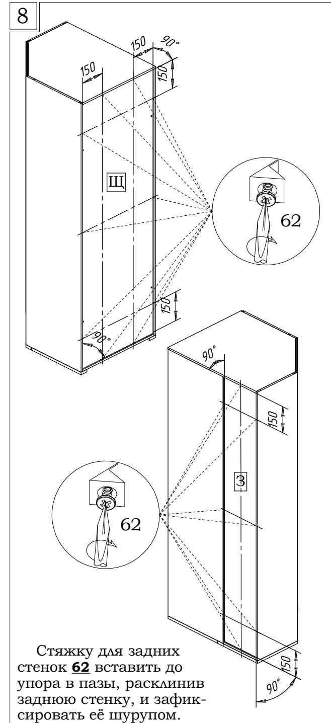
Стяжку для задних стенок **62** вставить до упора в пазы, расклинить заднюю стенку, и зафиксировать её шурупом.
