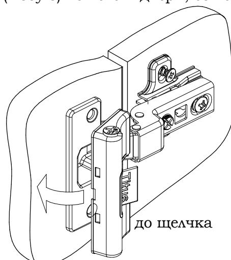
Вращая регулировочный винт доводчика, установите необходимое усилие закрытия двери.
