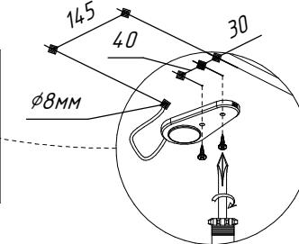
Просверлите сквозное отверстие  $\phi 8\text{мм}$  для провода и сделайте наколки для крепления светильника согласно схемы. Установите светильник.
