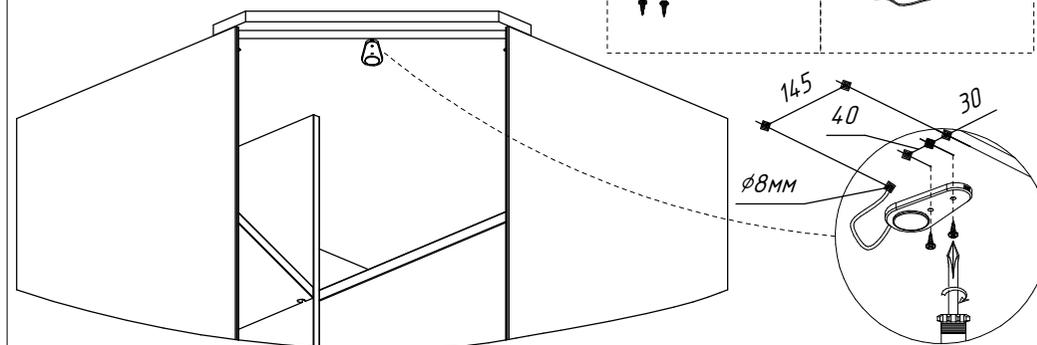
Просверлите сквозное отверстие  $\phi 8\text{мм}$  для провода и сделайте накладки для крепления светильника согласно схеме. Установите светильник.
