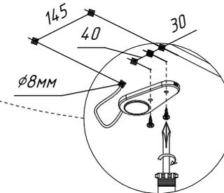
Просверлите сквозное отверстие  $\phi 8\text{мм}$  для провода и сделайте накладки для крепления светильника согласно схеме. Установите светильник.
