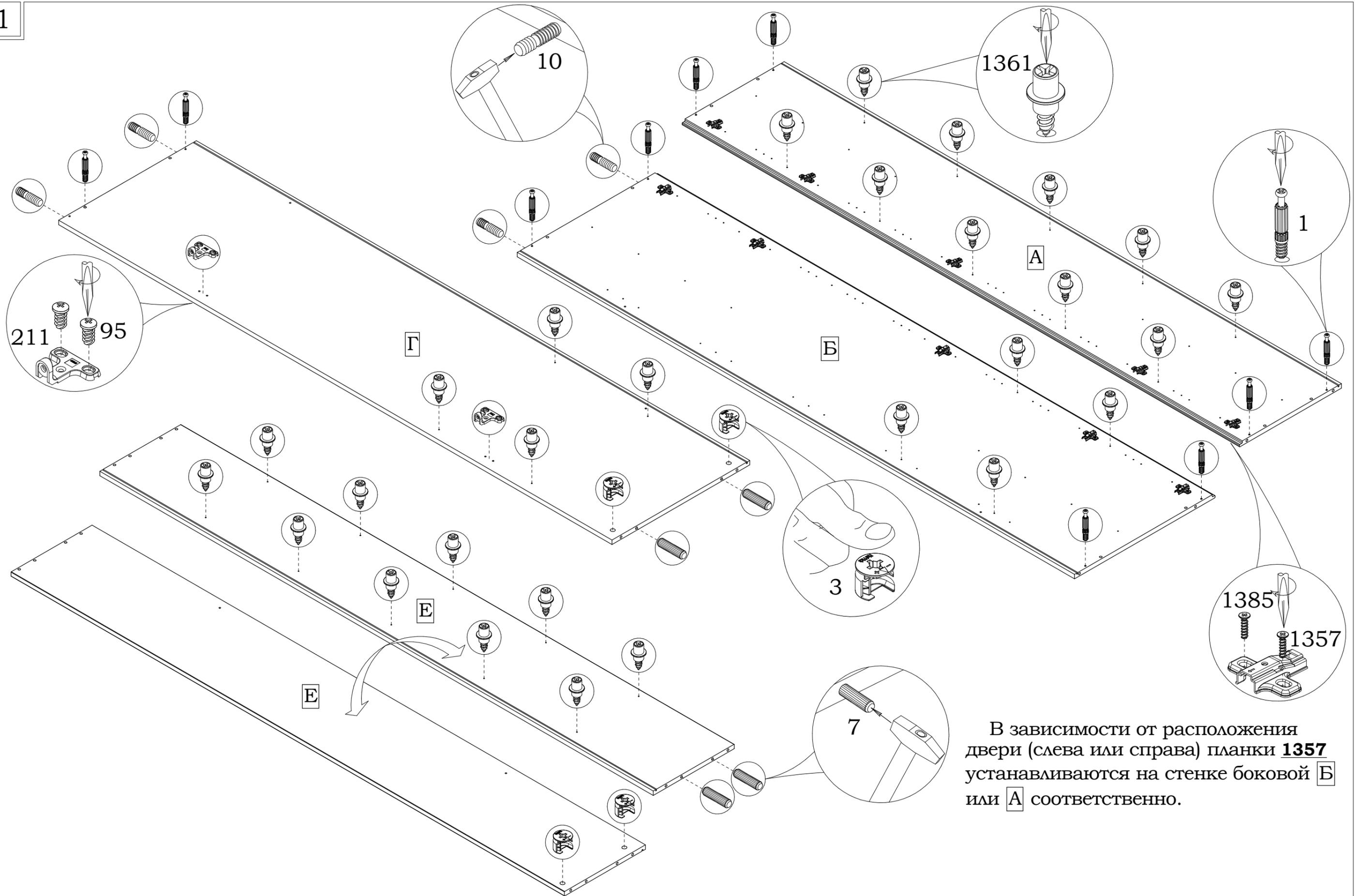
В зависимости от расположения двери (слева или справа) планки **1357** устанавливаются на стенке боковой **Б** или **А** соответственно.
