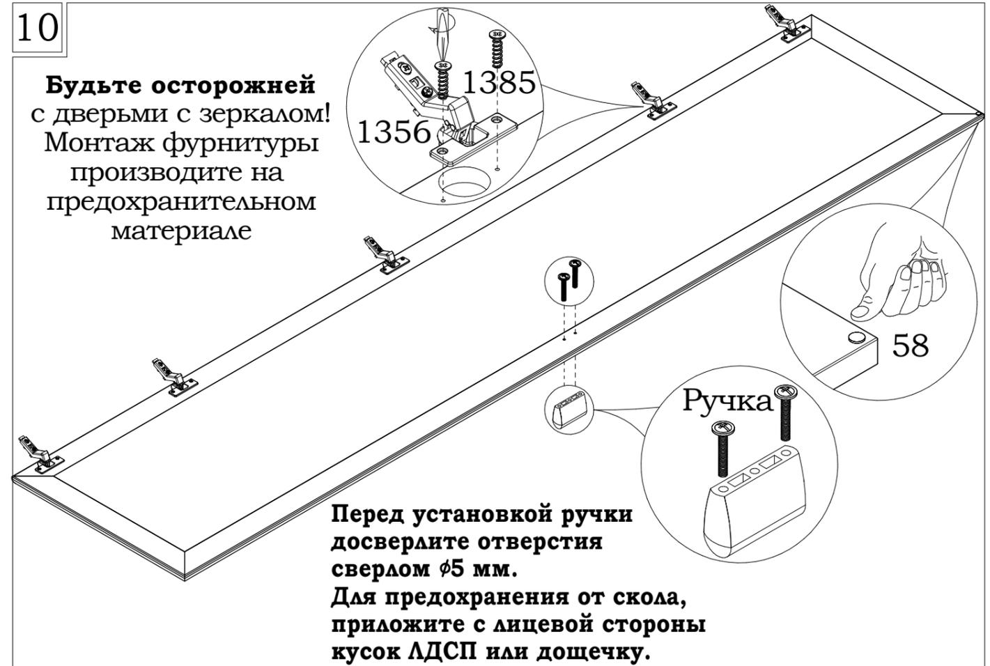
Перед установкой ручки досверлите отверстия сверлом  $\phi 5$  мм.
