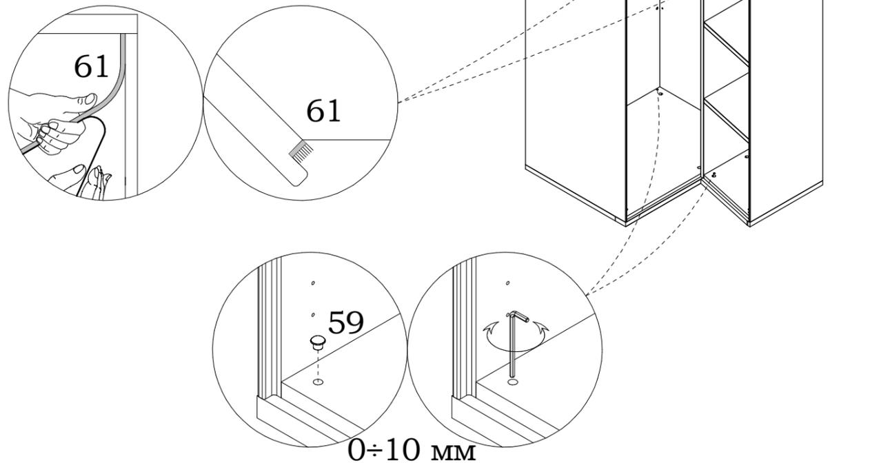
Выравнивание шкафа по высоте произвести вращением опор с помощью шестигранного ключа.
