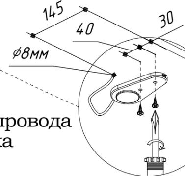
Просверлите сквозное отверстие  $\phi 8\text{мм}$  для провода и сделайте накладки для крепления светильника согласно схеме. Установите светильник.
