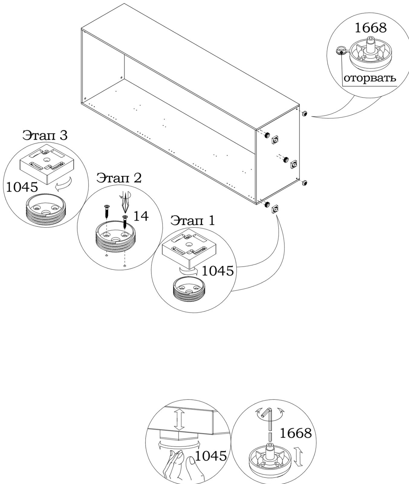
Выравнивание изделия по высоте спереди произвести поворачиванием вращающихся частей регулируемых опор **1045**, а сзади вращением опор **1668** с помощью шестигранного ключа.
