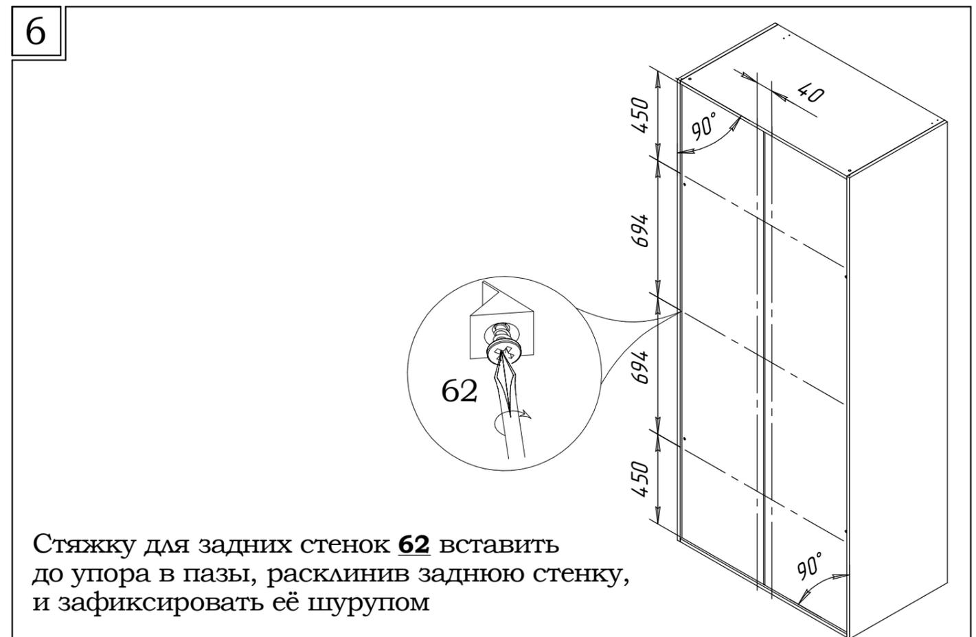
Стяжку для задних стенок **62** вставить до упора в пазы, расклинив заднюю стенку, и зафиксировать её шурупом
