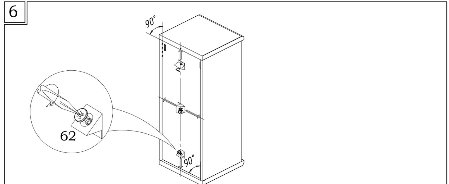
Стяжку для задних стенок **62** вставить до упора в пазы, расклинив заднюю стенку, и зафиксировать её шурупом.
