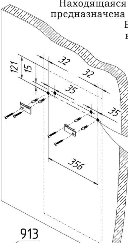
Находящаяся в комплекте фурнитура для укрепления на стенах предназначена исключительно для применения в прочной кладке. В случае если стены сделаны из другого материала, как, например, стены с применением облегчённых конструкций, необходимо использовать подходящую для них фурнитуру.
