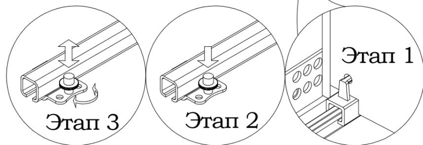
1. Выдвинуть направляющие, вставить ящик под наклоном так, чтобы два отверстия на стенке задней ящика попали на крючки;
