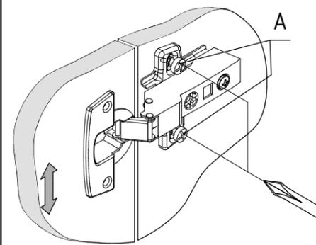
**б) Регулирование глубины**
