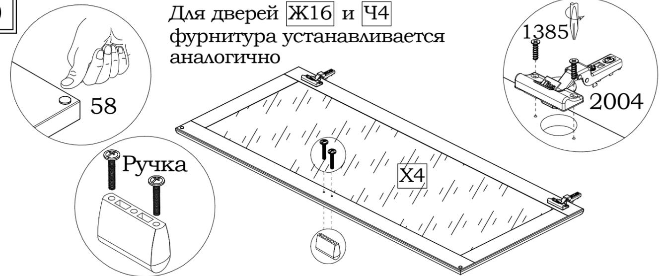
Перед установкой ручки досверлите отверстия сверлом  $\phi 5$  мм. Для предохранения от скола, приложите с лицевой стороны кусок ЛДСП или дощечку.
