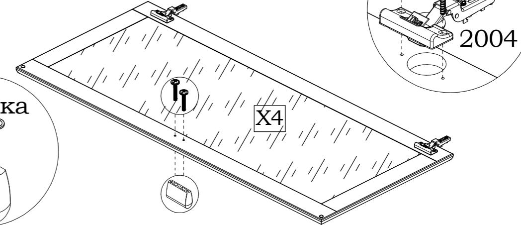
Перед установкой ручки досверлите отверстия сверлом  $\phi 5$  мм.
