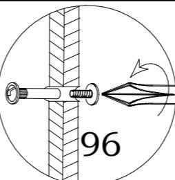
Для соединения шкафа с другими изделиями, через боковины просверлить электродрелью отверстия  $\phi 5$  мм, предварительно выровняв шкаф и изделие по высоте. Соединить их при помощи межсекционных стяжек 96 .
