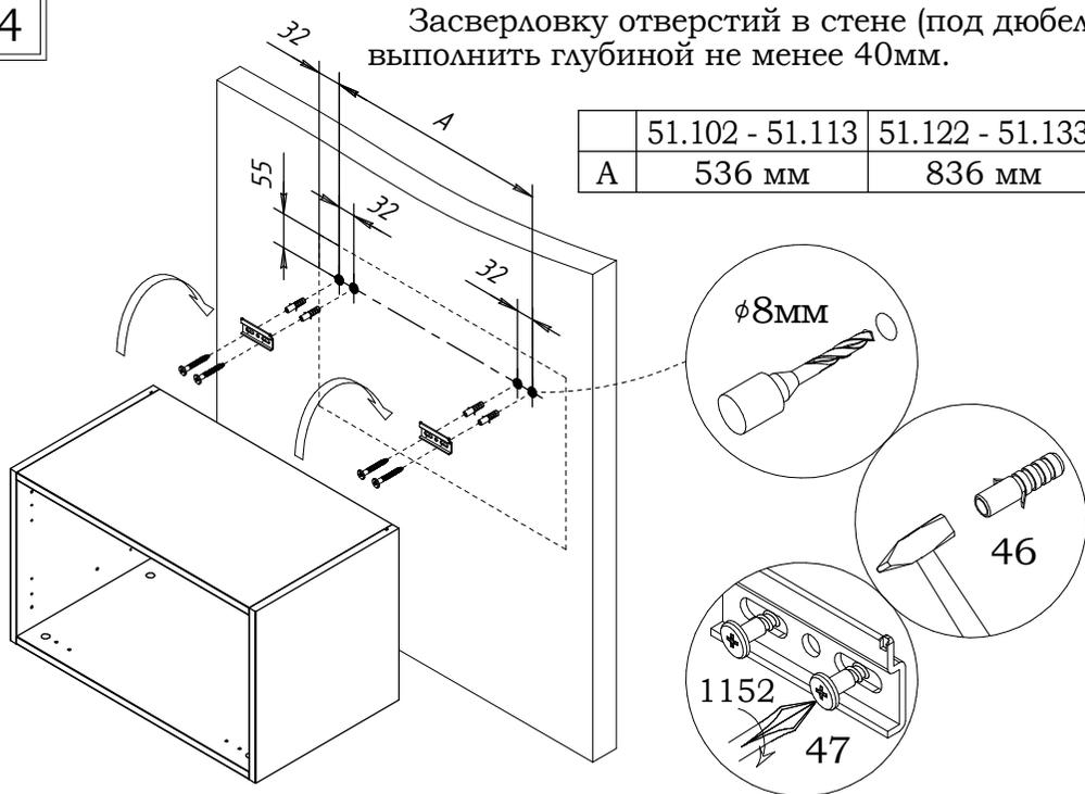
Находящаяся в комплекте фурнитура для крепления на стенах предназначена исключительно для применения в прочной кладке. В случае, если стены сделаны из другого материала, как, например, стены с применением облегчённых конструкций, необходимо использовать подходящую для них фурнитуру.
