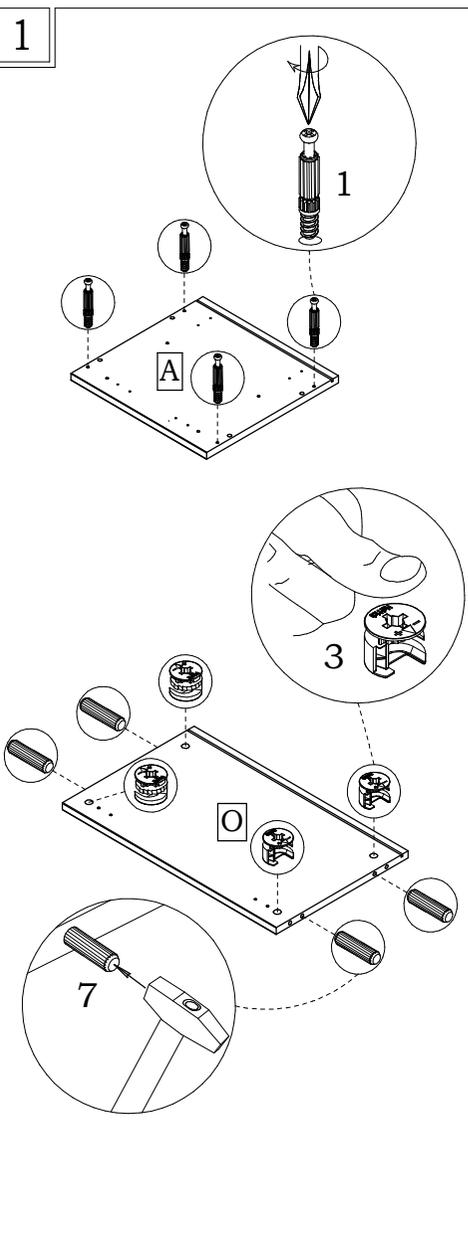
Для вторых стенок боковой **A** и горизонтальной **O** данные операции по установке фурнитуры повторить.
