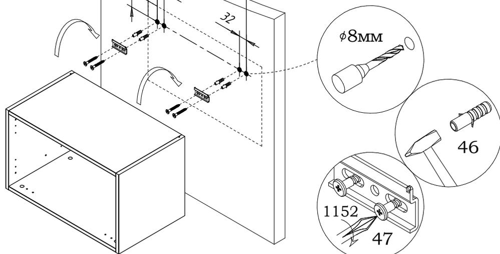
Находящаяся в комплекте фурнитура для крепления на стенах предназначена исключительно для применения в прочной кладке. В случае, если стены сделаны из другого материала, как, например, стены с применением облегчённых конструкций, необходимо использовать подходящую для них фурнитуру.
