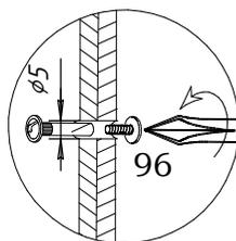
Соединить изделия между собой при помощи межсекционных стяжек **96** через отверстия в стенках боковых. Отверстия  $\phi 5$  мм просверлить электродрелью в стенках боковых, предварительно выровняв изделия.
