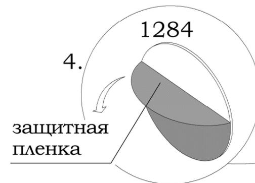
4. Снять защитную плёнку с ответной планки **1284** и приклеить её к двери строго напротив магнита толкателя **1973**.
