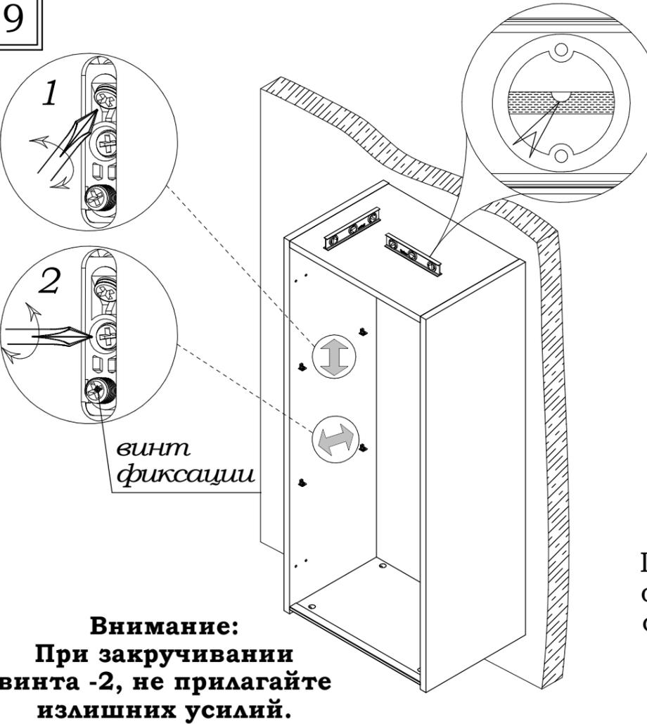
Перед регулировкой по глубине, открутите винт фиксации. см. рис. 2
