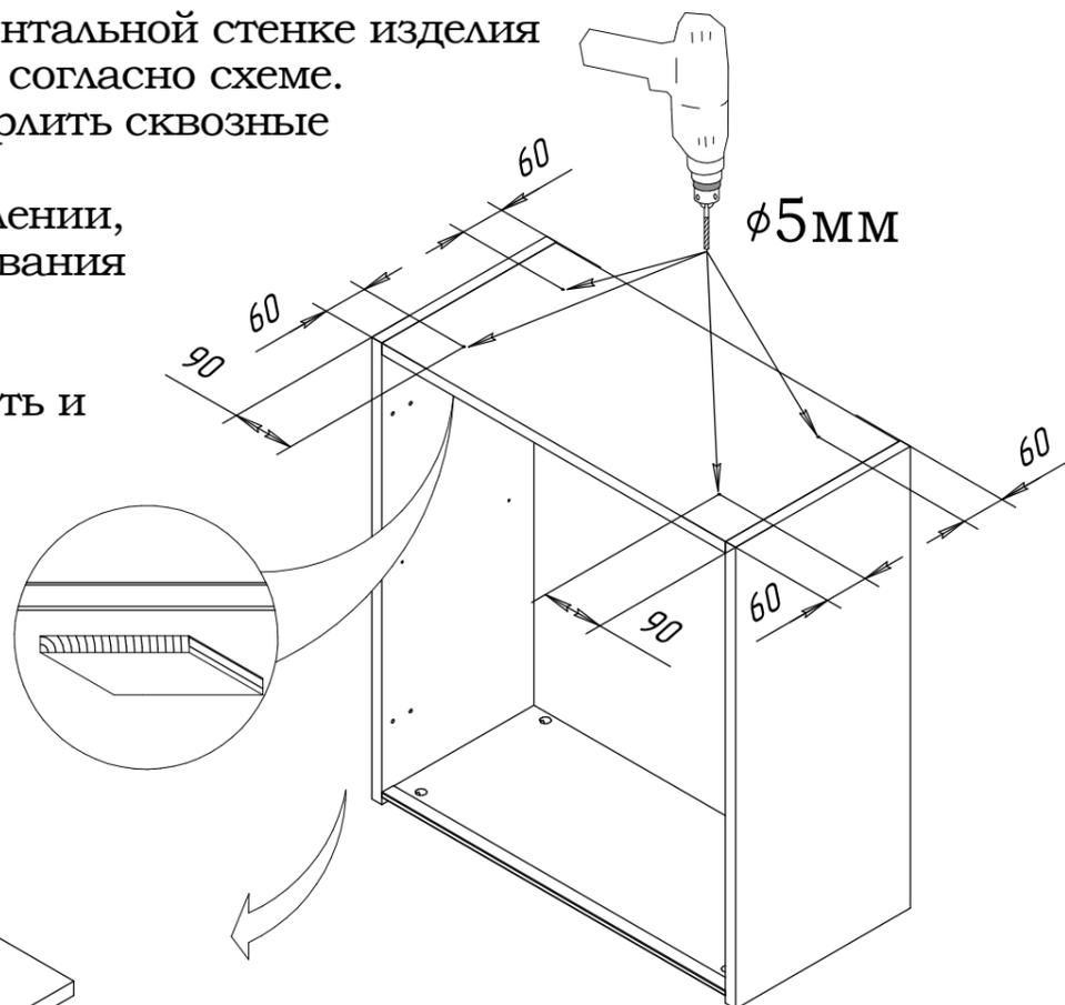
3. Разместить крышку на изделие, выравнивая по задней кромке, обеспечивая равномерные свесы по бокам, плотно прижать крышку к изделию.
