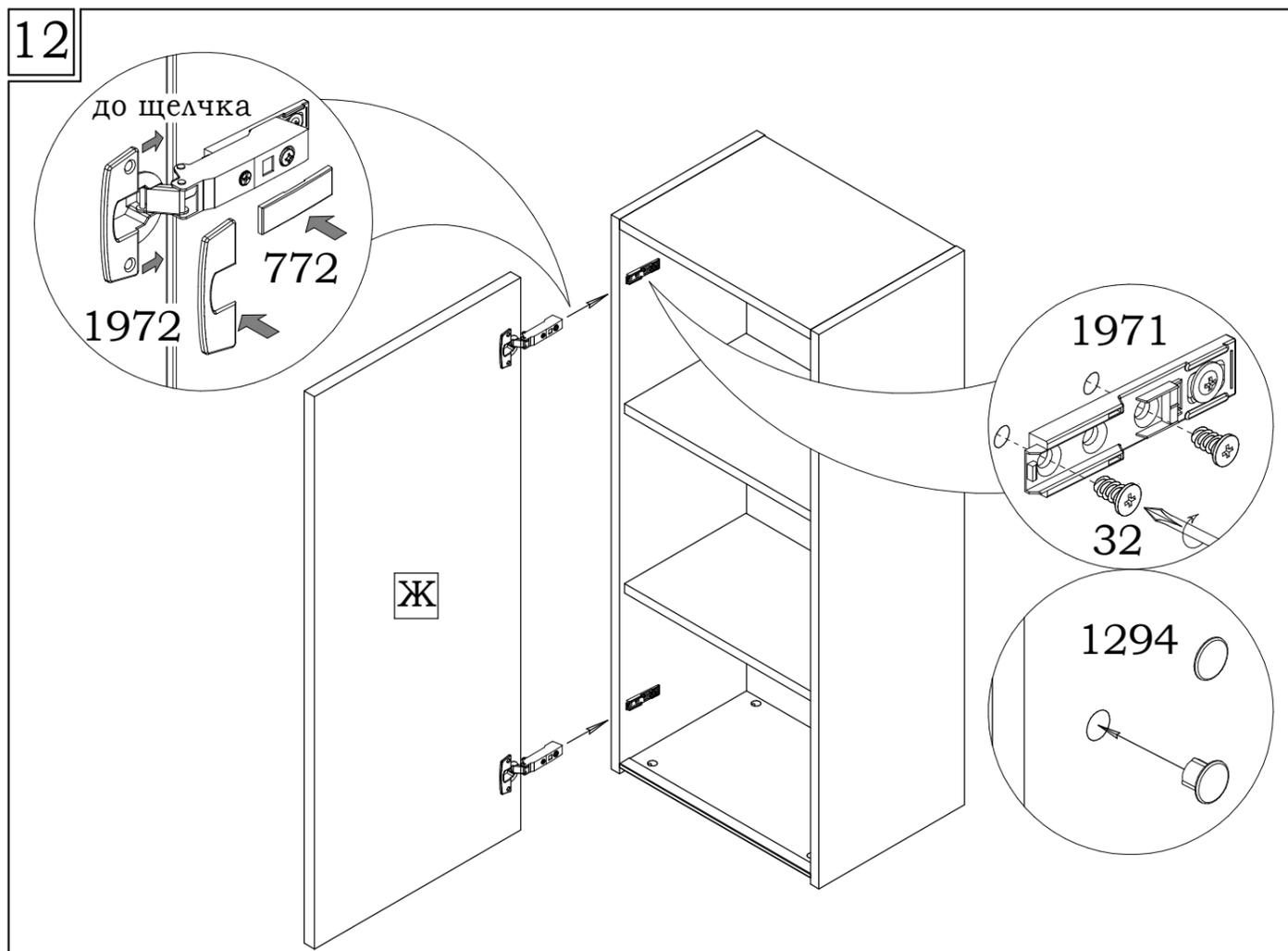
В зависимости от открывания двери - левое или правое, планки ответные **1971** могут быть установлены как на левую, так и на правую стенку боковую. Не используемые отверстия под планку ответную на противоположной боковой стенке закрыть заглушками **1294**.
