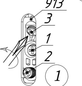
**1** Используя отвертку, вывернуть винт для навески -1 (до упора) и стопорный винт -2 в крайнее положение, против часовой стрелки. Винтом -3 установите среднее положение вертикального хода навески.
