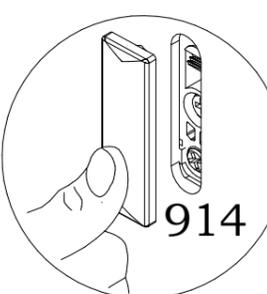
После регулировки, отверстия в задних стенках заглушить.
