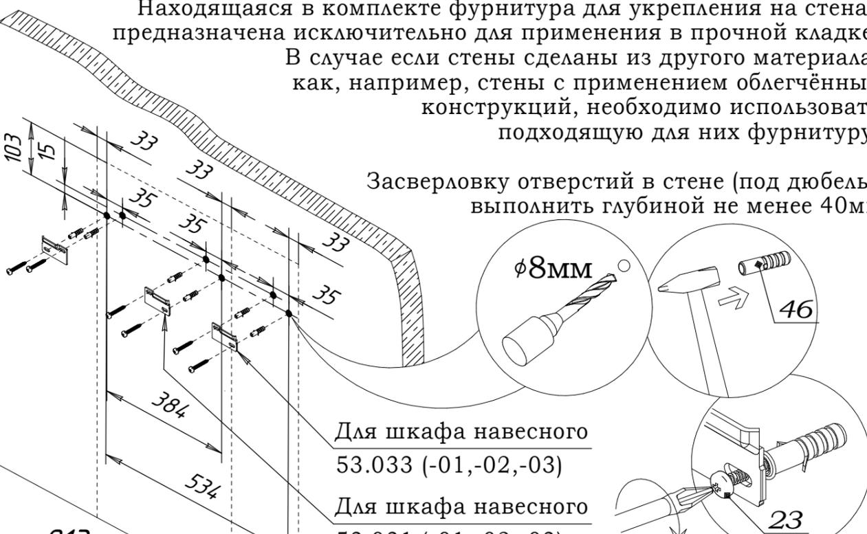
Находящаяся в комплекте фурнитура для укрепления на стенах предназначена исключительно для применения в прочной кладке. В случае если стены сделаны из другого материала, как, например, стены с применением облегчённых конструкций, необходимо использовать подходящую для них фурнитуру.
