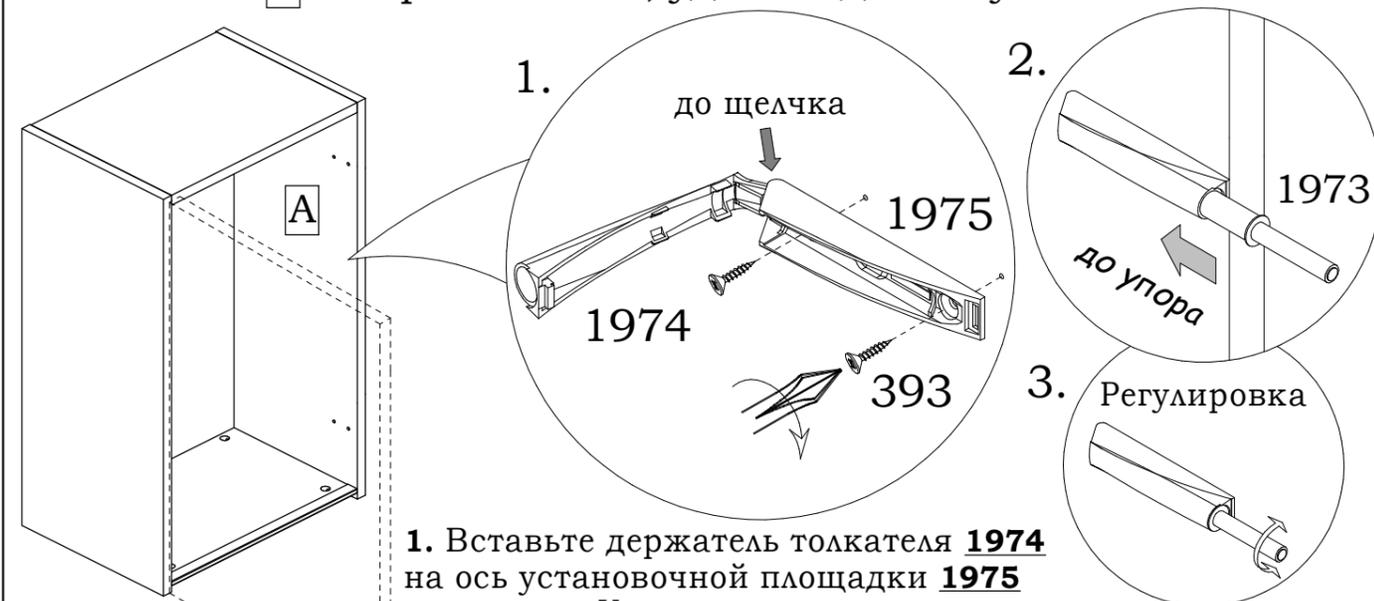
1. Вставьте держатель толкателя **1974** на ось установочной площадки **1975** до щелчка. Установите площадку на стенку боковую **A** с помощью шурупов **393** (при необходимости сделайте электродрелью отверстия  $\phi 3\text{ мм}$  и глубиной  $5\text{ мм}$  в местах крепления), выровняв площадку **1975** по передней кромке стенки боковой **A**. Затем поверните держатель **1974** и защёлкните в площадке **1975**.
