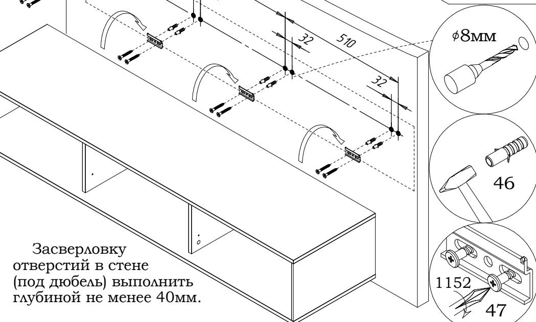
Находящаяся в комплекте фурнитура для крепления на стенах предназначена исключительно для применения в прочной кладке. В случае, если стены сделаны из другого материала, как, например, стены с применением облегчённых конструкций, необходимо использовать подходящую для них фурнитуру.
