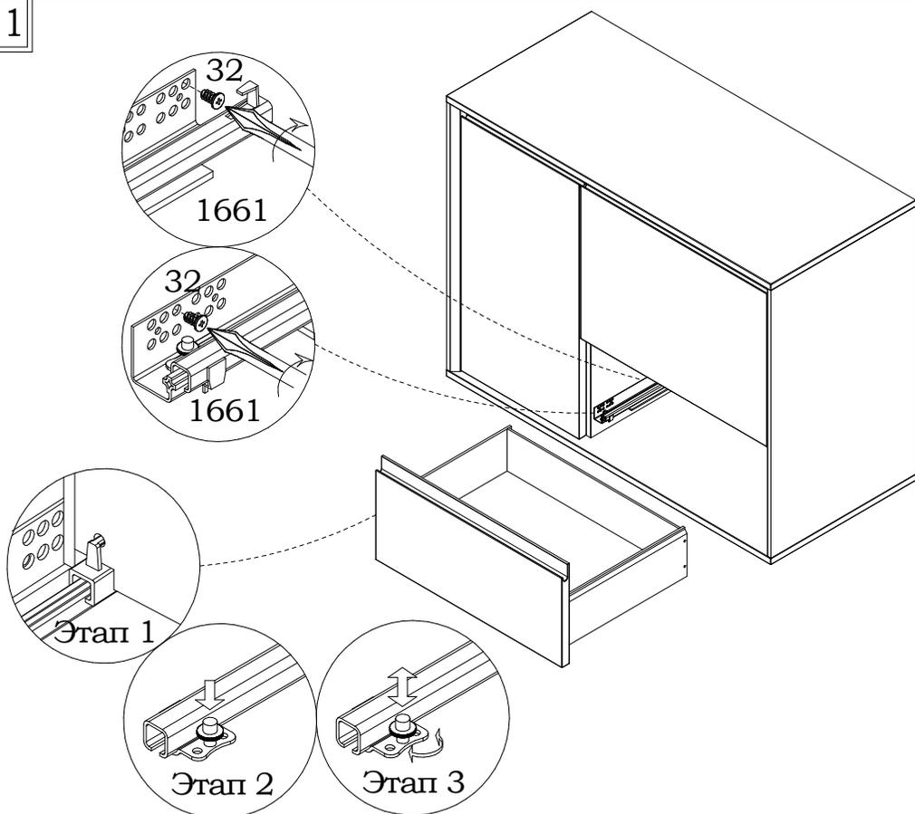
1. Выдвинуть направляющие, вставить ящик под наклоном так, чтобы два отверстия на стенке задней ящика попали на крючки;
