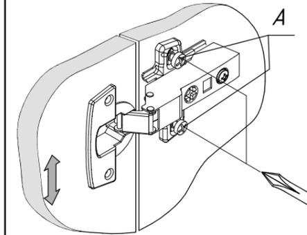
**б) Регулирование глубины**
