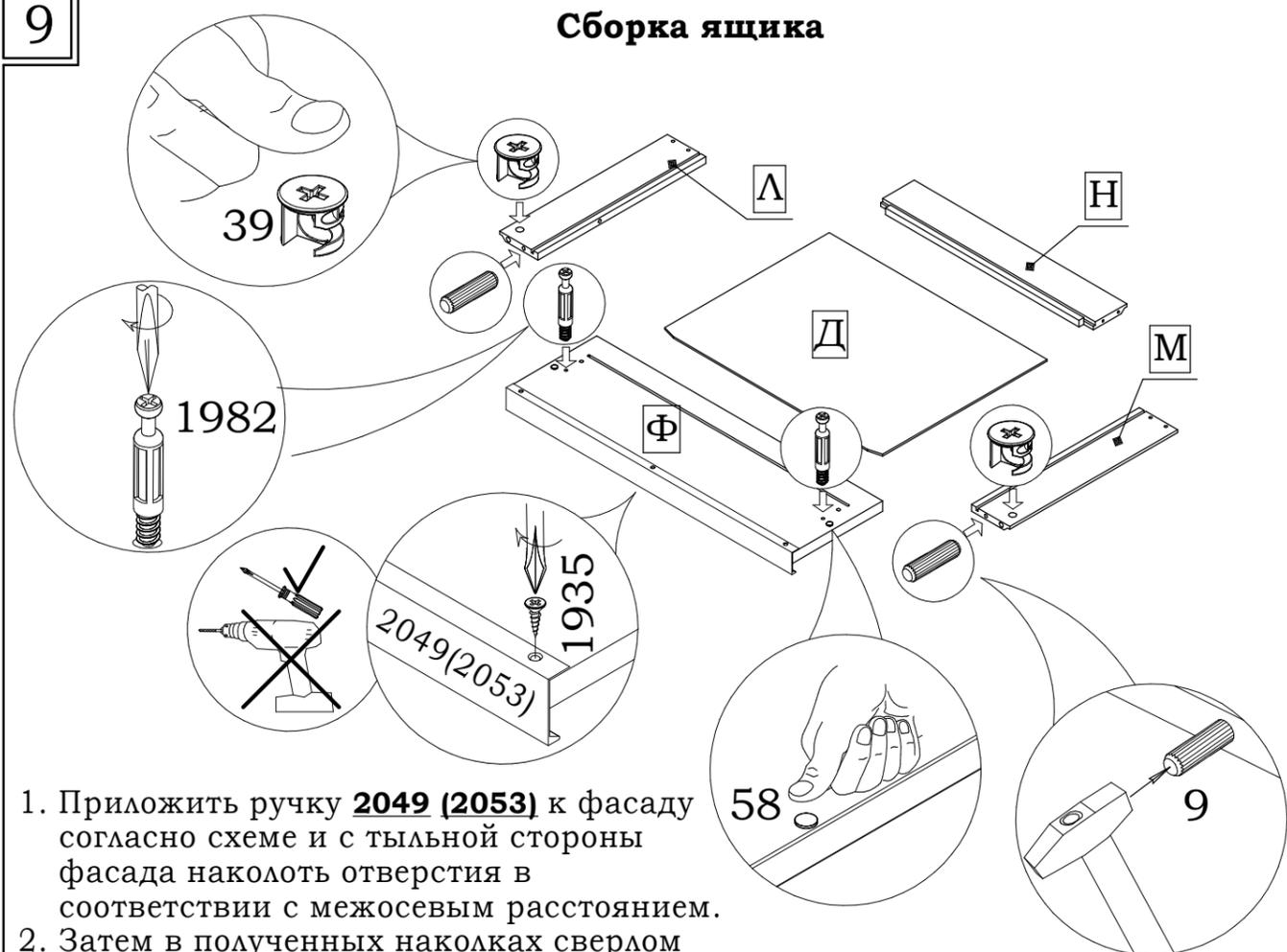
1. Приложить ручку **2049 (2053)** к фасаду согласно схеме и с тыльной стороны фасада наколоть отверстия в соответствии с межосевым расстоянием.
