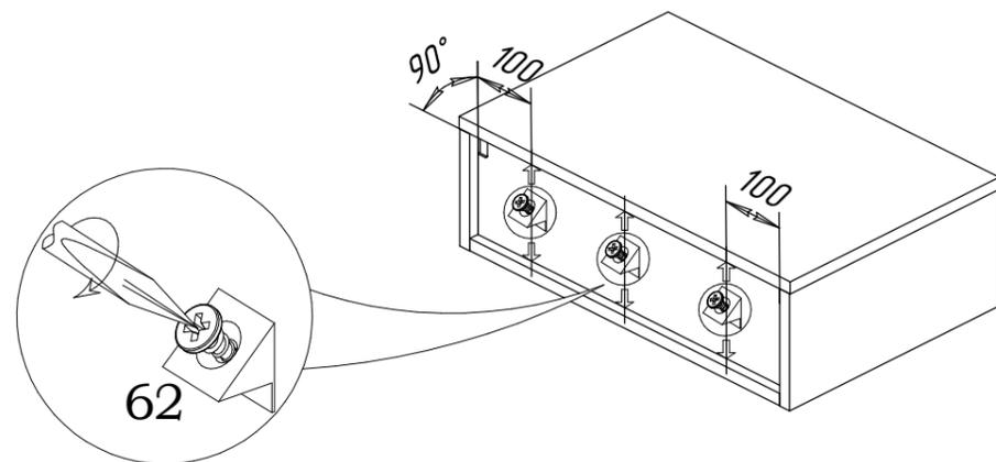
Стяжку для задних стенок **62** вставить до упора в пазы, расклинив заднюю стенку и зафиксировать её шурупом.
