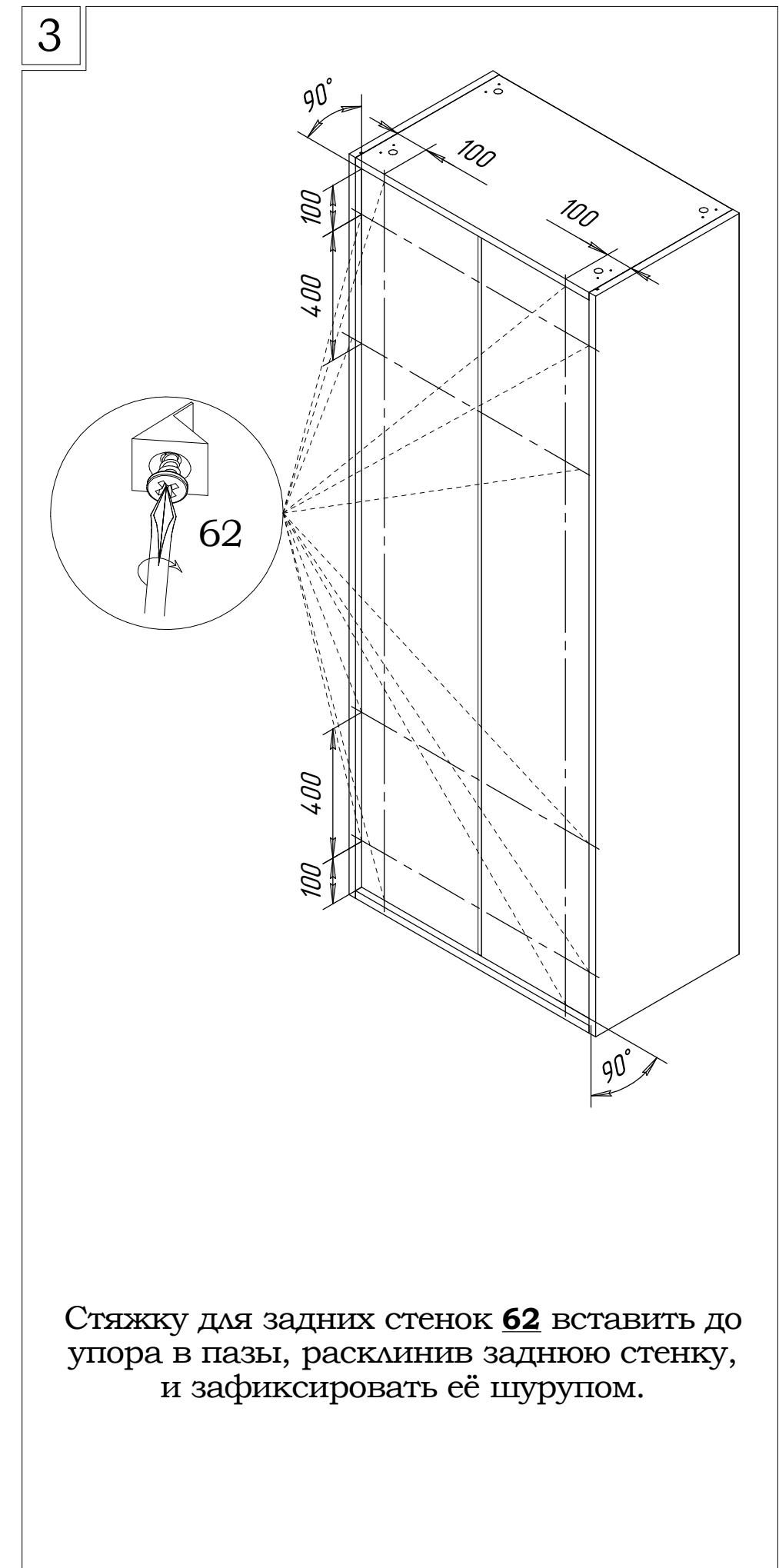
Стяжку для задних стенок **62** вставить до упора в пазы, расклинив заднюю стенку, и зафиксировать её шурупом.
