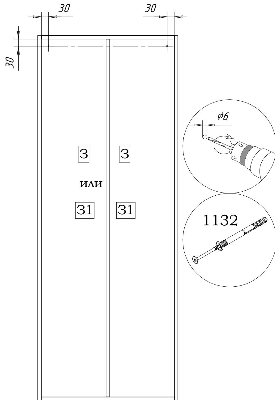
1. Просверлить отверстия  $\phi 6$  мм задней стенке **3** или **31** согласно схемы.
