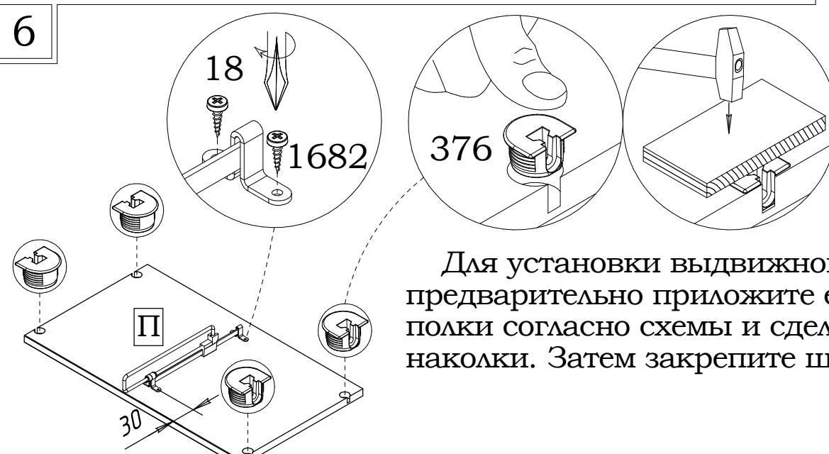
Для установки выдвижного вешало предварительно приложите его посередине полки согласно схемы и сделайте шилом наколки. Затем закрепите шурупами **18**.
