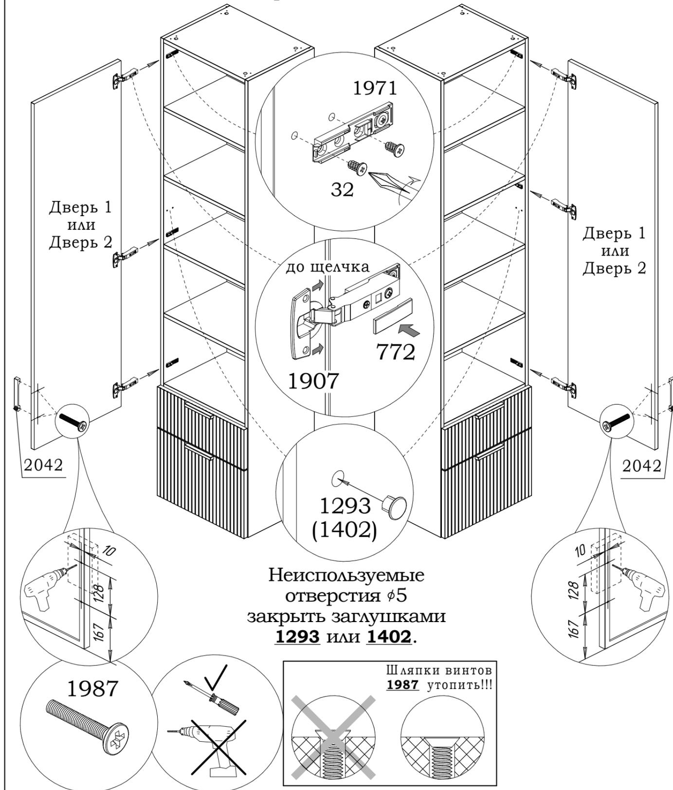
На лицевой стороне двери аккуратно разметить и просверлить 2 сквозных отверстия  $\phi 5$  мм согласно схемы.
