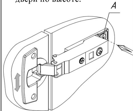
**б) Регулирование глубины**
