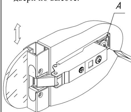
**б) Регулирование глубины**
