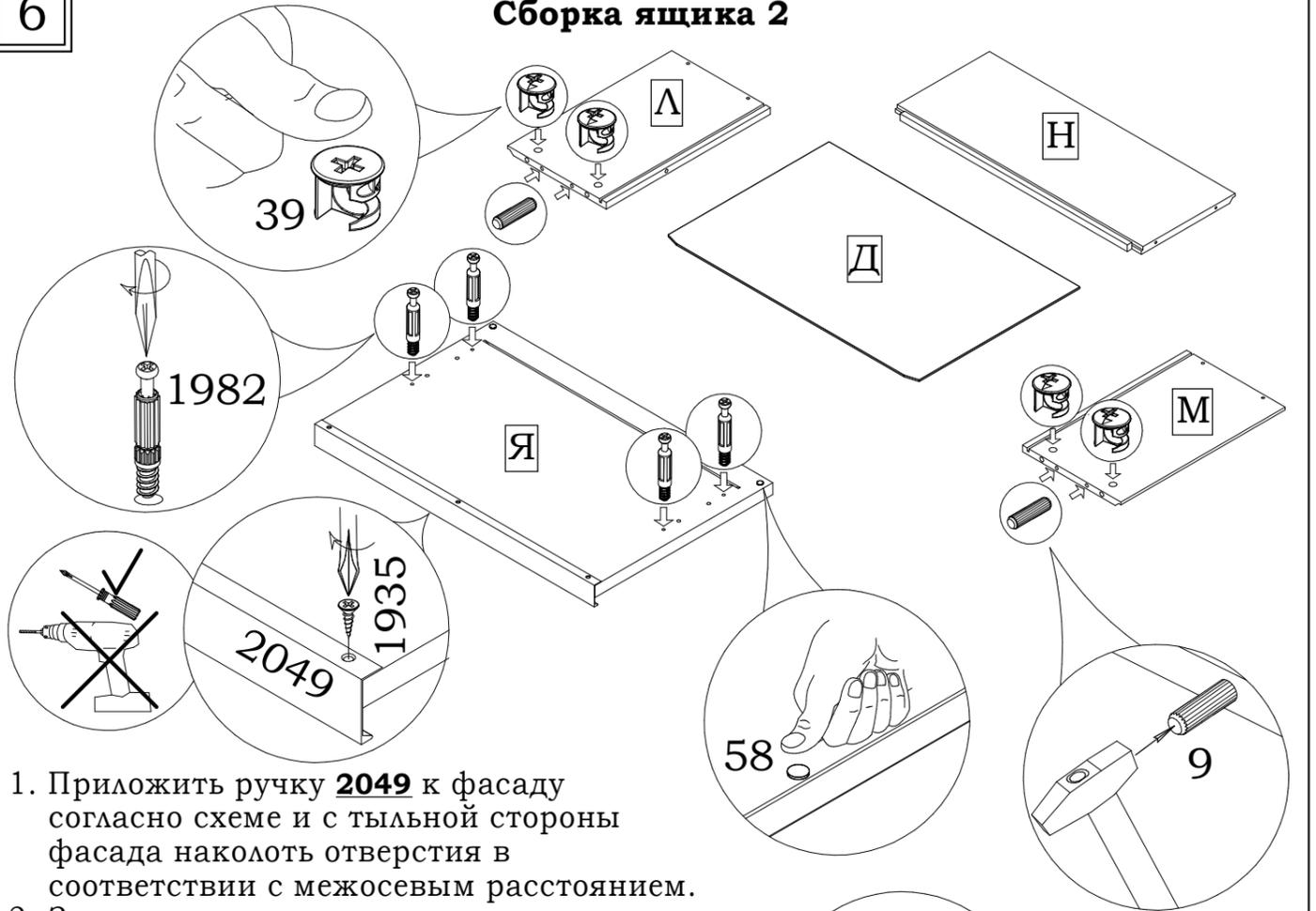
1. Приложить ручку **2049** к фасаду согласно схеме и с тыльной стороны фасада наколоть отверстия в соответствии с межосевым расстоянием.
