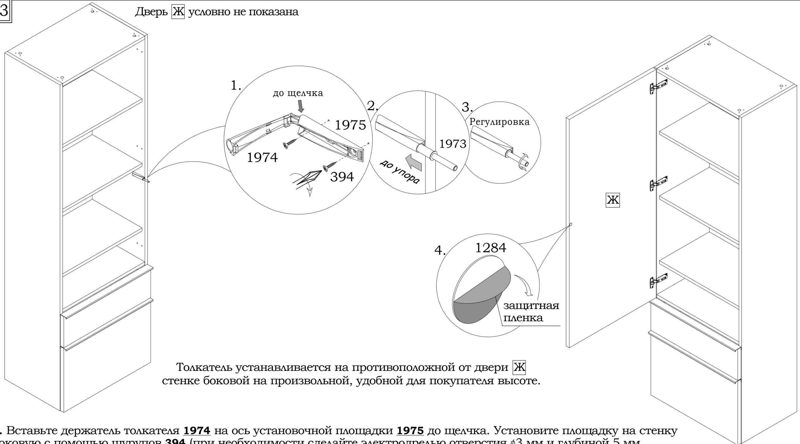
Толкатель устанавливается на противоположной от двери Ж стенке боковой на произвольной, удобной для покупателя высоте.
