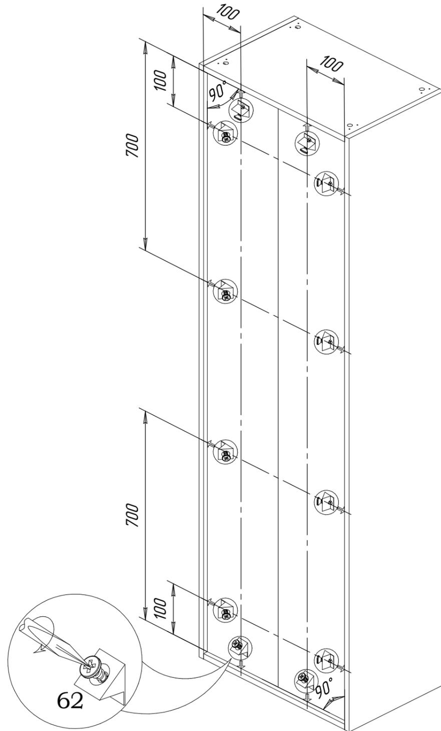
Стяжку для задних стенок **62** вставить до упора в пазы, расклинив заднюю стенку и зафиксировать её шурупом.
