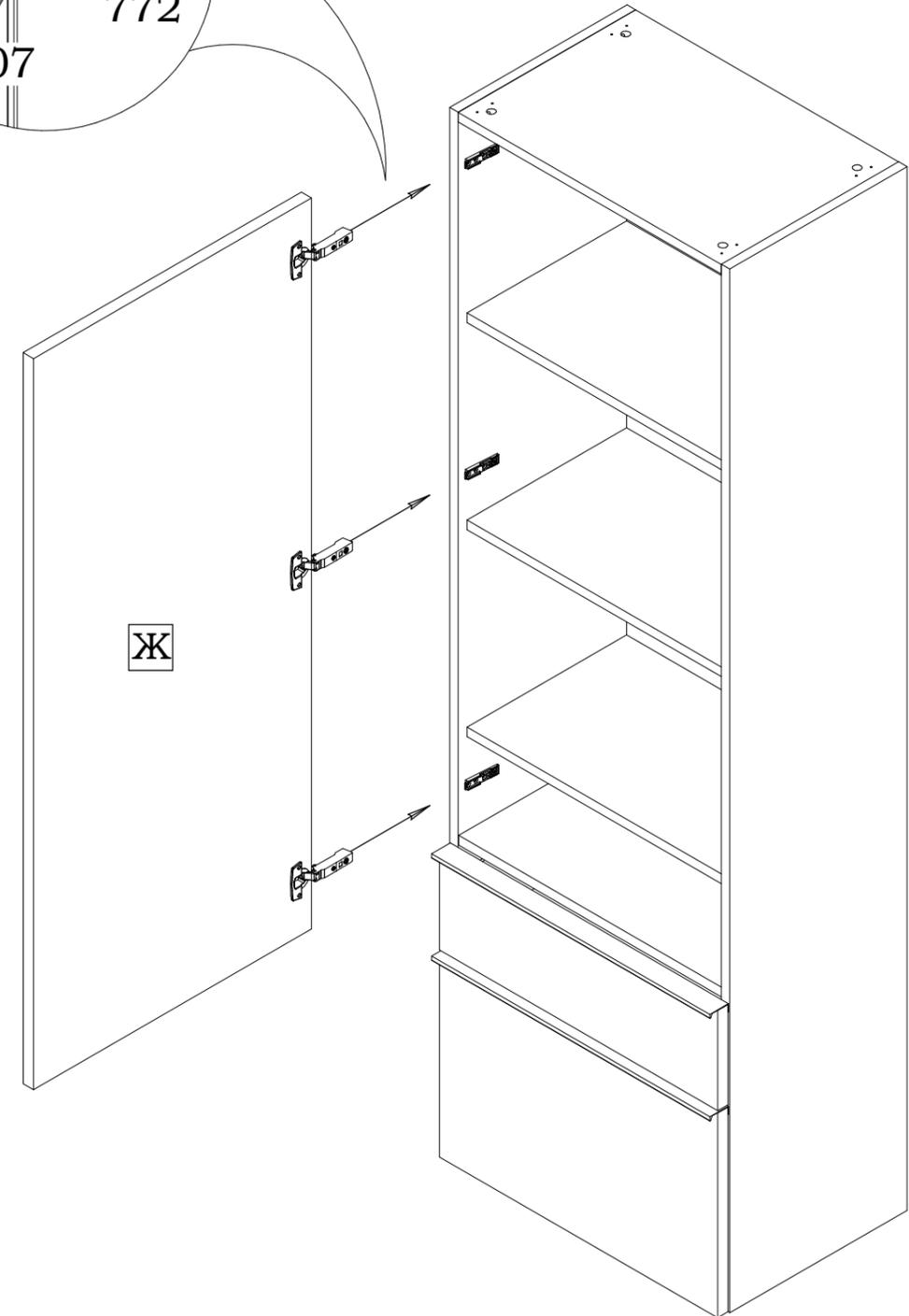
Для шкафа с левым открыванием двери навеска двери **Ж** производится на стенку боковую **А**, для шкафа с правым открыванием двери - на стенку боковую **Б**.
